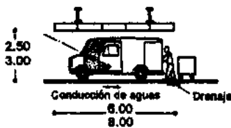
Patio de maniobras de Vans ligeras con bóveda cubierta
