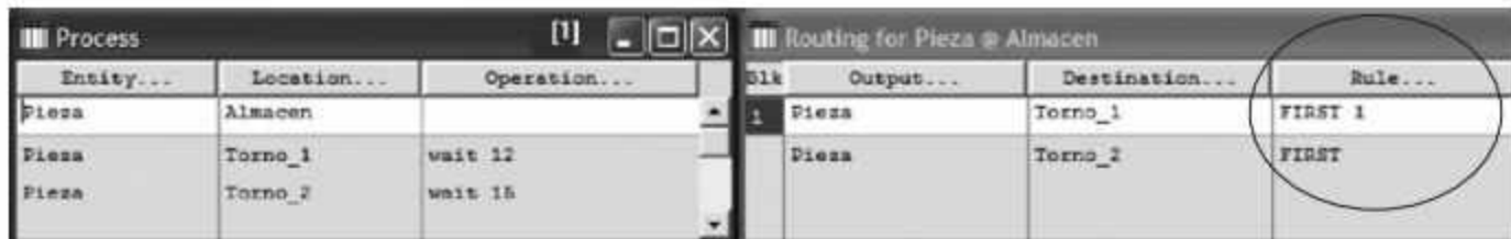
Figura 6.36 Selección del torno donde se procesará la pieza.
