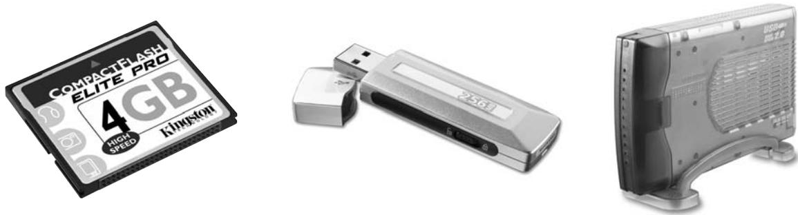
**Figura 1.9.** Memorias auxiliares: Tarjeta compact flash (izquierda), memoria flash USB (centro) y disco duro (derecha).
