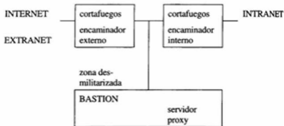
Figura 18.1. Protección de una red Intranet
