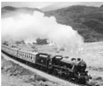
FIGURA 8-15 Al quemarse el combustible (una reacción química) se libera energía para hervir agua en esta locomotora. El vapor producido se expande contra un pistón que efectúa trabajo al mover las ruedas.
