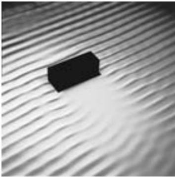
FIGURA 15-31 Difracción de onda. Las ondas llegan desde la esquina superior izquierda. Note cómo las ondas, conforme pasan el obstáculo, se doblan alrededor del mismo, en la “región de sombra” detrás del obstáculo.
