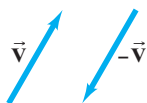
FIGURA 3-7 El negativo de un vector es un vector con la misma longitud y dirección, pero con sentido opuesto.
