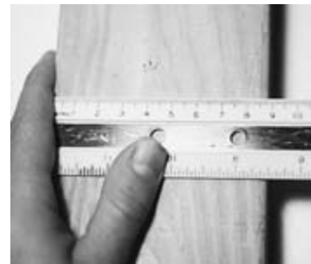
FIGURA 1–2 La medición del ancho de un tablón con una regla centimétrica. La incertidumbre es de aproximadamente \pm 1 mm.
