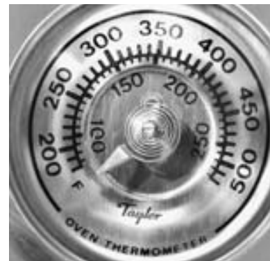
FIGURA 17-6 Fotografía de un termómetro que usa una tira bimetaléica enrollada.
