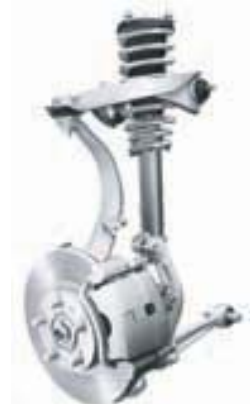
FIGURA 14-4 Fotografía de un resorte automotriz. (Se observa también el amortiguador; véase la sección 14-7).
