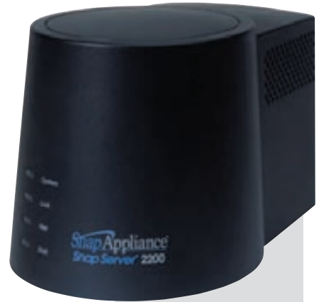
Figura 10.7. Un dispositivo de almacenamiento RAID combina varios discos duros para crear un almacenamiento de datos redundante que pueda resistir un fallo del hardware.
