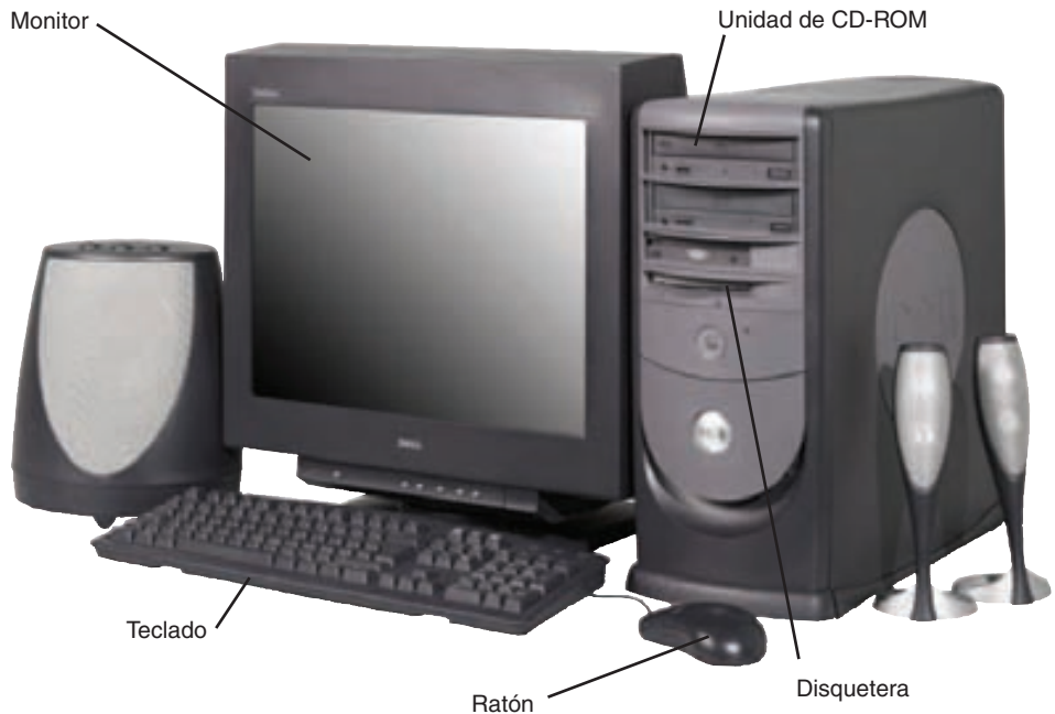
Figura 0.2. Un PC o un Mac estándares están hechos de varios componentes, incluyendo una unidad del sistema, un monitor, un teclado y un ratón. La unidad del sistema incluye generalmente un disco duro interno y una unidad óptica, como, por ejemplo, un CD-ROM o una unidad de DVD.
