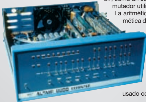
Figura 2.2. La MITS Altair, la primera computadora personal, no tenía teclado ni monitor. Sólo podía programarse manipulando un banco de conmutadores binarios en el panel frontal a modo de entrada (entrada de datos). Los patrones binarios de luces proporcionaban la salida.
