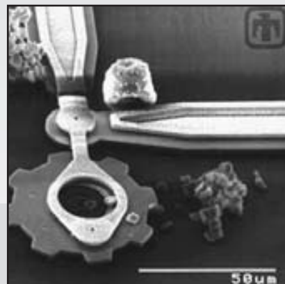
Figura 10.8. Estas micromáquinas no son mucho mayores que los glóbulos rojos de la sangre (abajo a la derecha y arriba a la izquierda) o que un grano de polen (arriba a la derecha).
