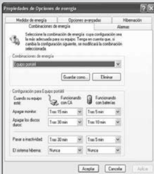
Figura 2.15. Los sistemas Windows y Mac OS X tienen paneles de control avanzados para configurar el ahorro de energía que pueden utilizarse para cambiar automáticamente el monitor, el disco duro y la CPU a modos de menor consumo después de periodos especificados de inactividad.
