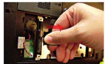
↑ Extracción del disco duro con su carcasa.
