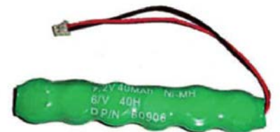
↑ Pila con funda adaptadora para su conexión a la placa base, de un equipo portátil.
