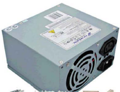
↑ Fuente de alimentación modelo AT con sus conectores.
