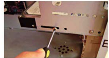
↑ Atornillado del disco duro (2).
