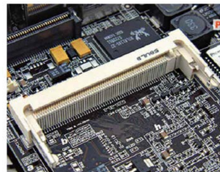
↑ Slot Mini-PCI Tipo III.
