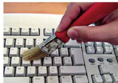
↑ Limpieza superficial del teclado con una brocha.
