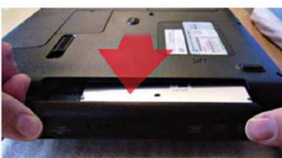
↑ Extracción de la unidad óptica.
