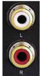
→ Puerto RCA analógico de salida izquierda/ mono y derecha.
