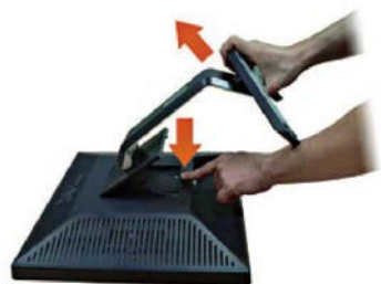
↑ Desmontaje de la base de un monitor.
