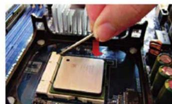
↑ Movimiento de cierre del socket (5).
