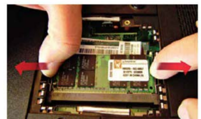
↑ Extracción del módulo de memoria.
