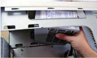
↑ Colocación de la fuente de alimentación (1).
