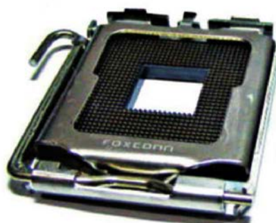
↑ Socket con sistema de conexión LGA.
