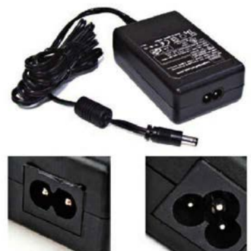
↑ Fuente de alimentación de un portátil y sus conectores.
