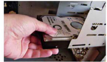
↑ Colocación del disco duro (1).
