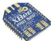
Módulo ZigBee con conector de antena UFI.
