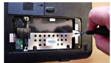
↑ Liberación de la carcasa del disco.
