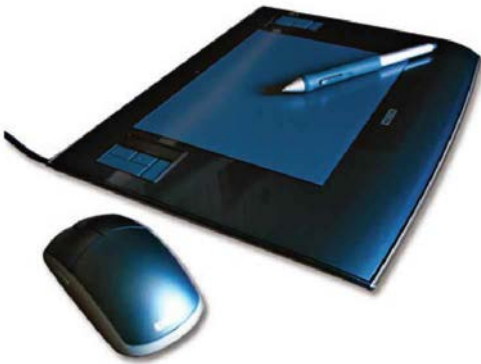
↑ Tableta gráfica con ratón especial y estilete.
