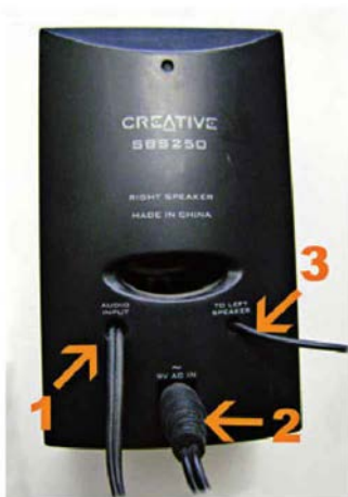
↑ Conexiones típicas de un sistema de sonido 2.0:
