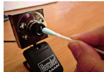
↑ Limpieza de la lente de una webcam utilizando un bastoncito impregnado en líquido limpiacristales.
