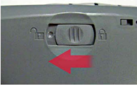
↑ Pestaña del bloqueo del carro en un escáner.
