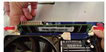
↑ Extracción del módulo de memoria.
