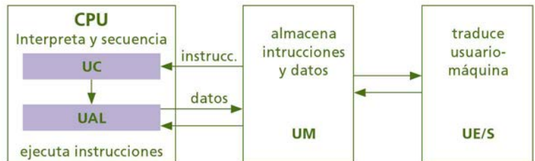
↑ Esquema básico de la arquitectura Von Neumann.
