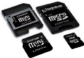
↑ Tarjetas mini y micro con sus respectivos adaptadores.
