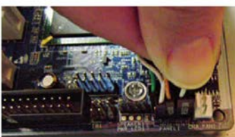
↑ Colocación de los jumpers del panel frontal de la caja.
