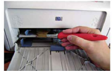
↑ Limpieza superficial de las bandejas de la impresora.
