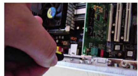
↑ Atornillado de la tarjeta a la caja (5).
