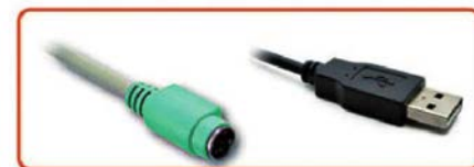
↑ Ratón con las dos conexiones más frecuentes.
