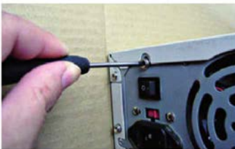
↑ Atornillado de la fuente de alimentación (2).
