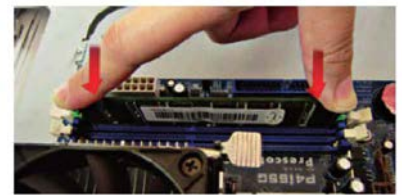
↑ Fijación del módulo en el zócalo (3).
