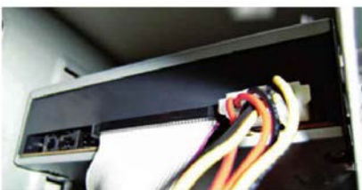
↑ Alimentación eléctrica de la unidad óptica.
