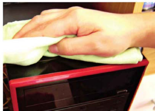
↑ Limpieza del exterior de la caja con un paño de microfibra humedecido con jabón.
