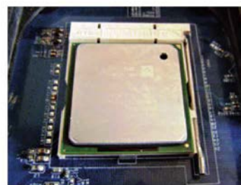
↑ Microprocesador correctamente encajado en el socket.
