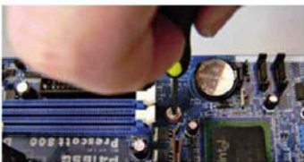
↑ Fijación de la placa base a la caja (5).
