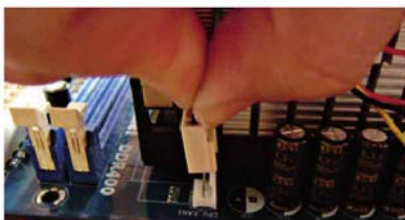
↑ Conexión de corriente del ventilador (5).
