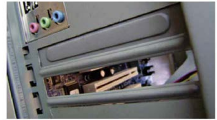
↑ Bahía sin pletina, preparada para colocar la tarjeta (1 y 2).
