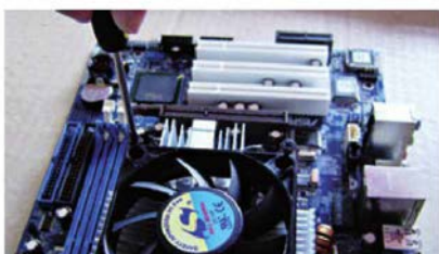
↑ Atornillado del ventilador (3).
