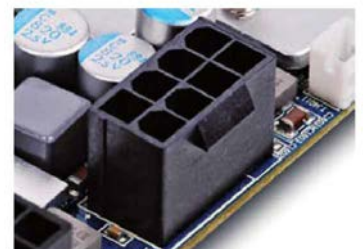
↑ Conector de corriente PEG de 8 contactos.
