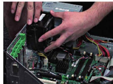
↑ Reemplazo del sistema de refrigeración como medida de mantenimiento correctivo.
