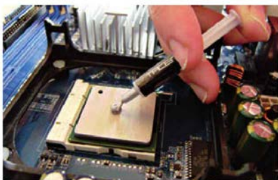
↑ Aplicación de masilla térmica (1).
