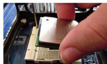
↑ Orientación y colocación del microprocesador (3 y 4).
