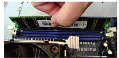
↑ Presentación del módulo en el zócalo (2).
