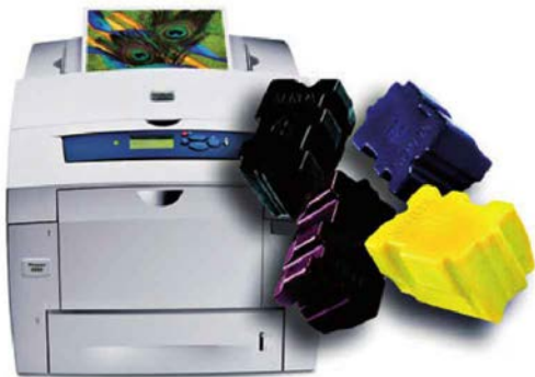
↑ Impresora de tinta sólida con sus cartuchos.
