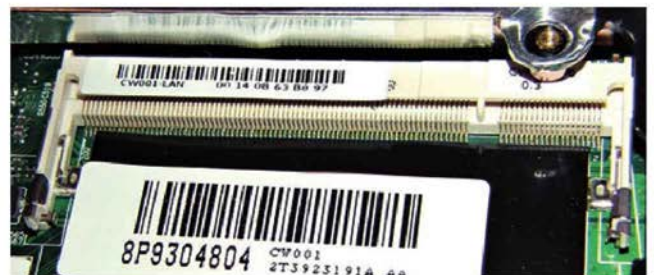
↑ Zócalo de memoria SO-DIMM de 204 contactos.
