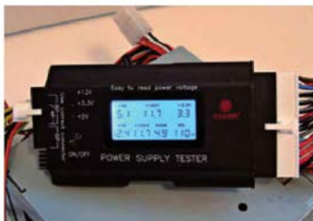
↑ Testeo de los cables de la fuente con un téster.
