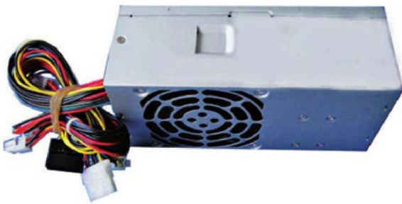
↑ Fuente de alimentación para placa Mini ITX.
