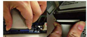
↑ Colocación del cable de datos a placa y al disco duro (3).
