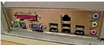
↑ Panel lateral con su correspondiente placa troquelada (4).
