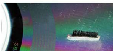
↑ Detalle de la escobilla que limpiará la lente del lector.
