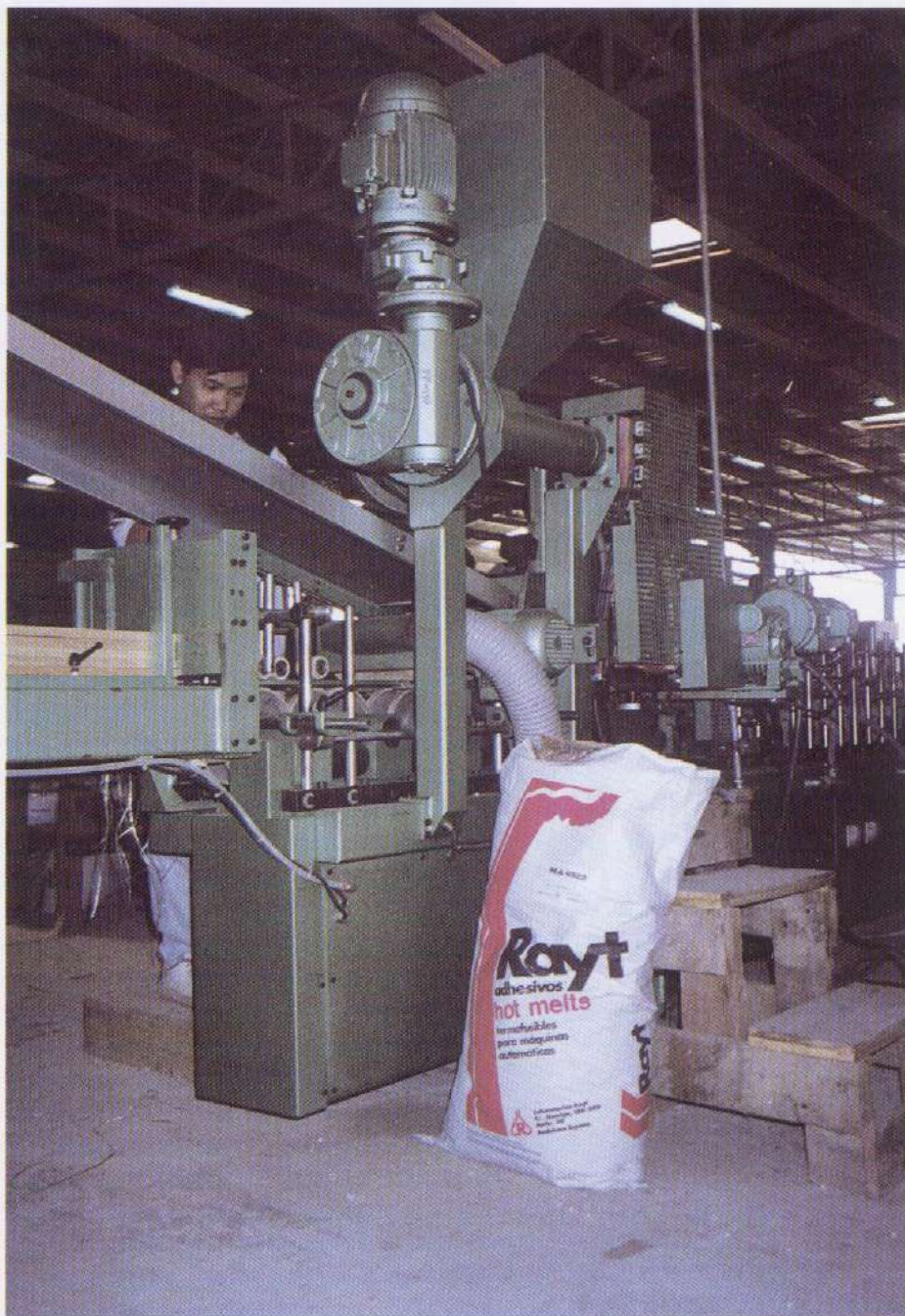
Maquinaria para revestir molduras
