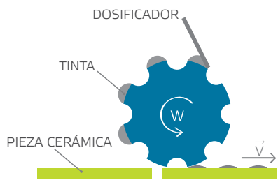
ESQUEMA 1.9. Esquema funcionamiento flexografía.
