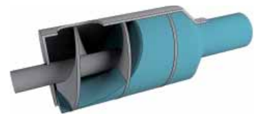
Extrusión a hélice
