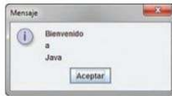
Fig. 3.17 | Uso de JOptionPane para mostrar varias líneas en un cuadro de diálogo (parte 2 de 2).
