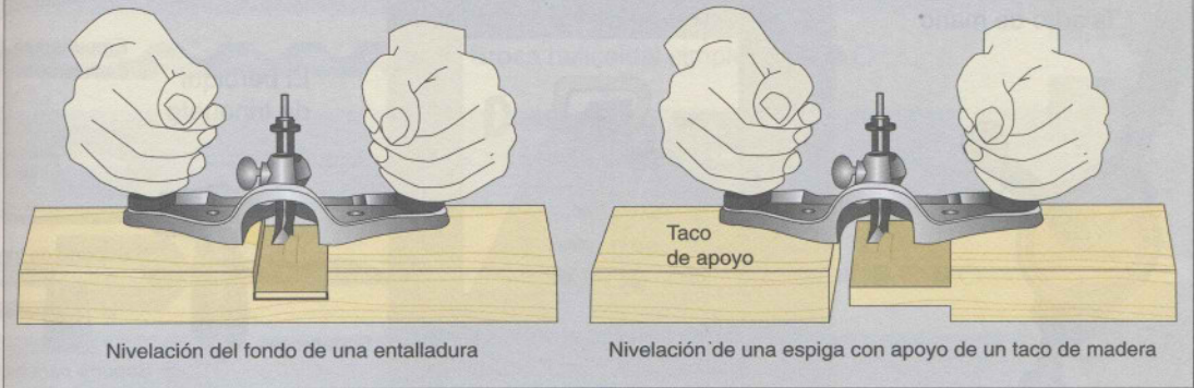
Figura 34. Utilización de la guimbarda de fondo
