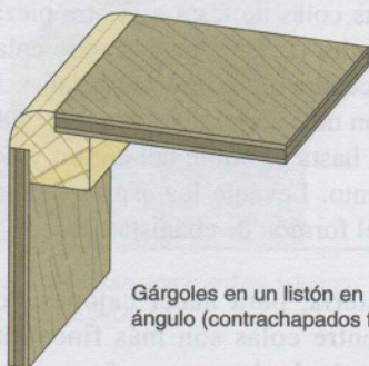
Ensamble de inglete con listón atornillado y encolado
