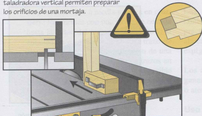
Figura 100. Realización mecánica de un ensamble con mortaja y espiga
