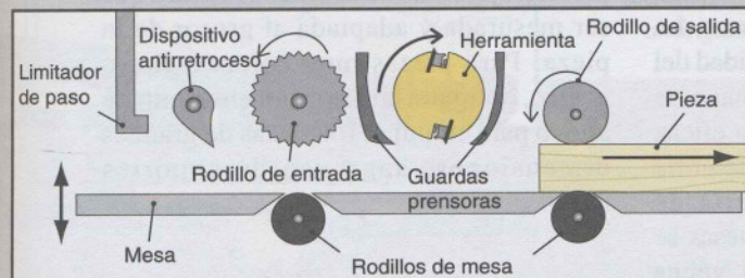
Utilización de la cepilladora
