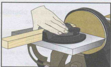
Lijado de madera a contrahilo en el disco. La pieza se sostiene contra la guía.
