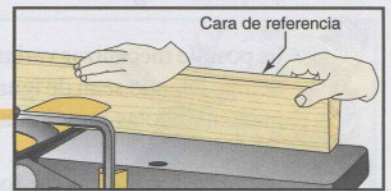
Montaje para cepillado en ristrel
