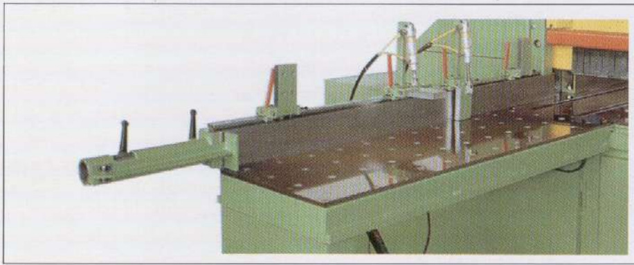
Detalle de mesa con cojín de aire para piezas pesadas.
