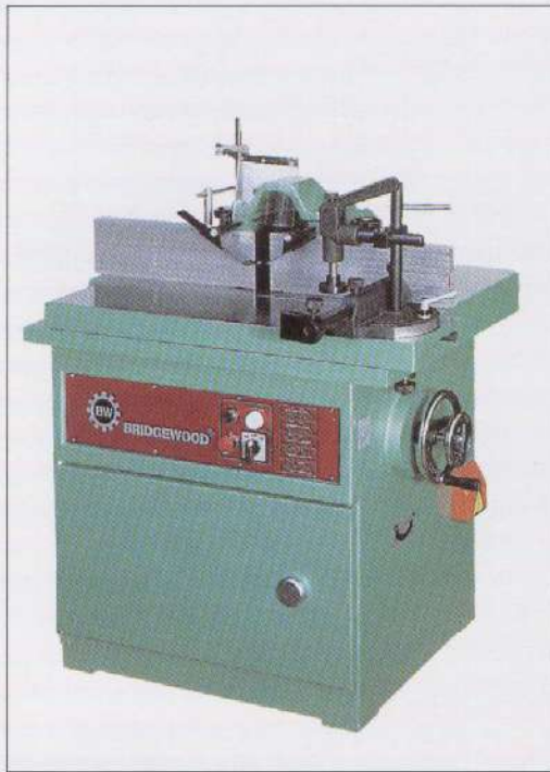
Fresadora especial con cinco velocidades para conseguir la velocidad adecuada.
