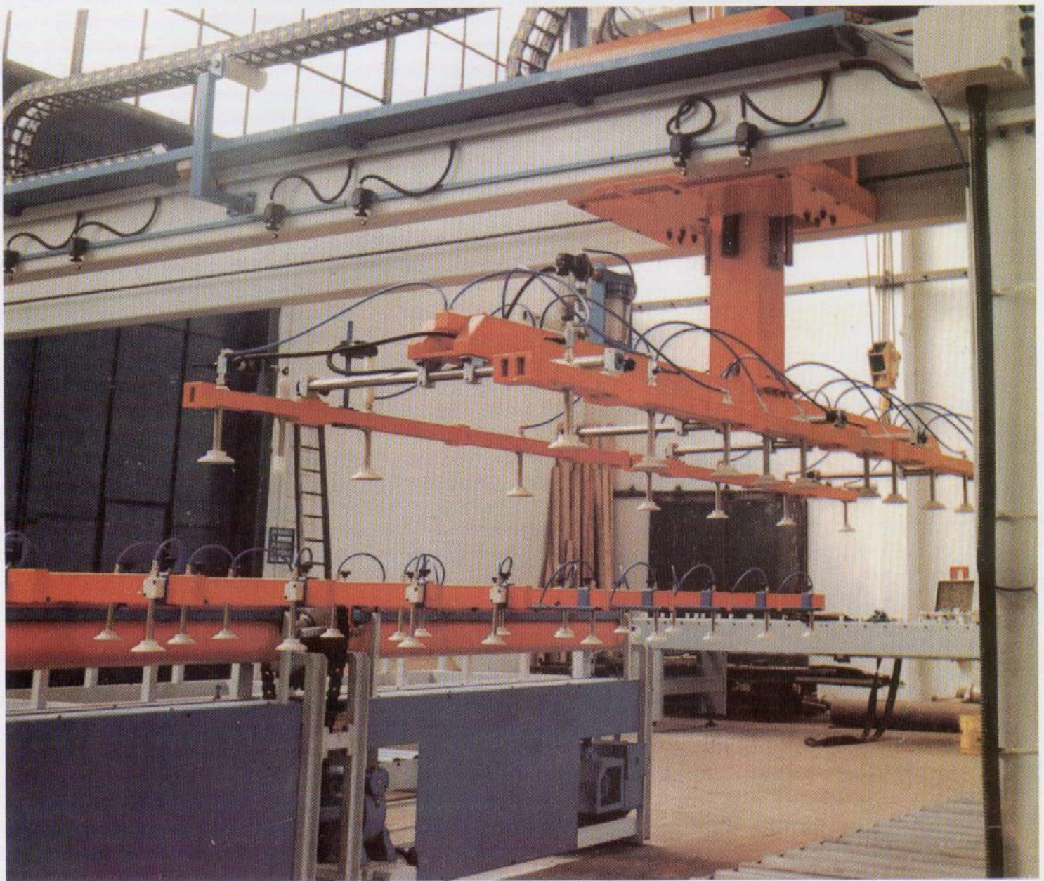
Transporte de piezas con máquina de ventosas con aire.
