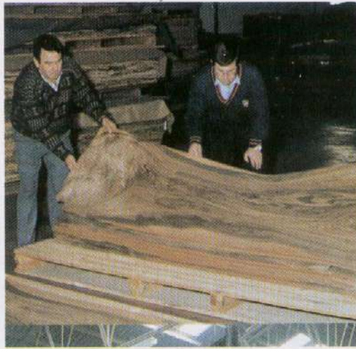
La manipulación de las chapas exige una ordenación en paquetes seriados.
