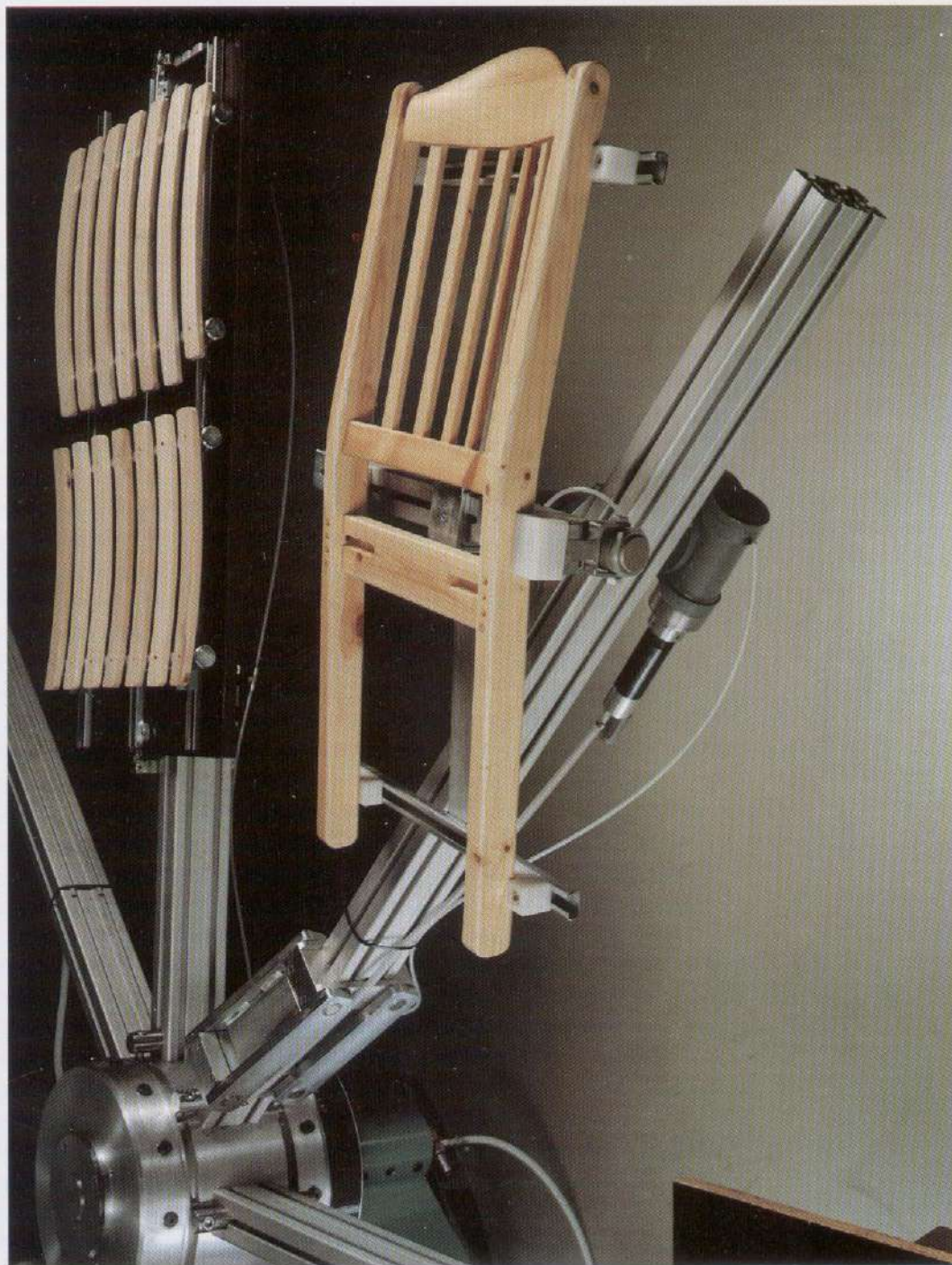
Detalle de sujeción de las piezas.
