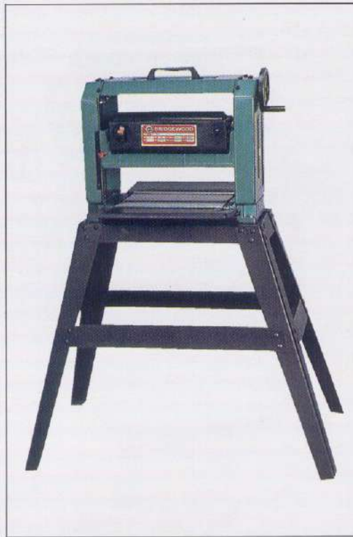
Regruesadora con plato de 350 mm de ancho, especial para obras.
