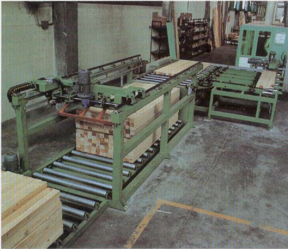
Transporte en doble sentido con apiladora automática.
