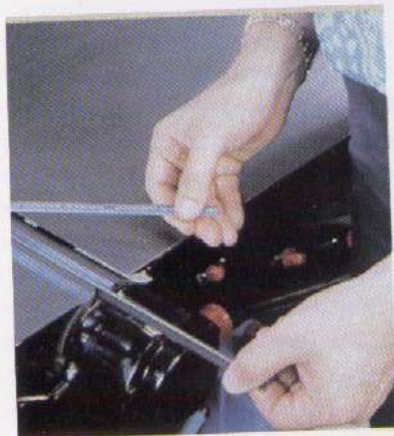
El control periódico de las cuchillas facilita un buen acabado y seguridad en el trabajo.
