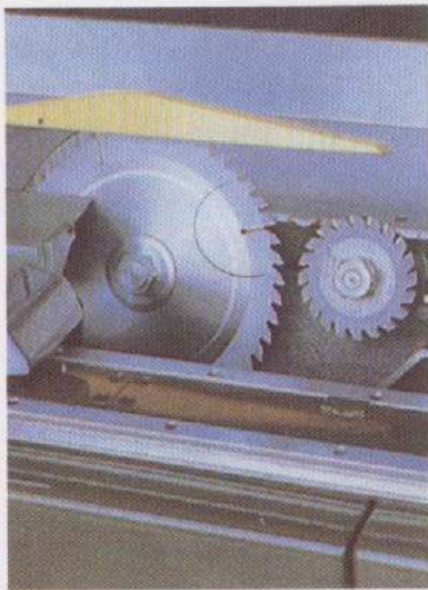
Detalle de disco e incisor con sentido de rotación contrario.
