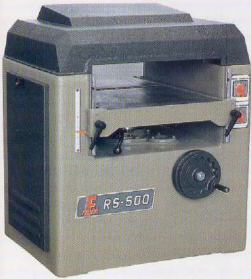
Regruesadora de alto rendimiento de 500 mm de ancho útil.
