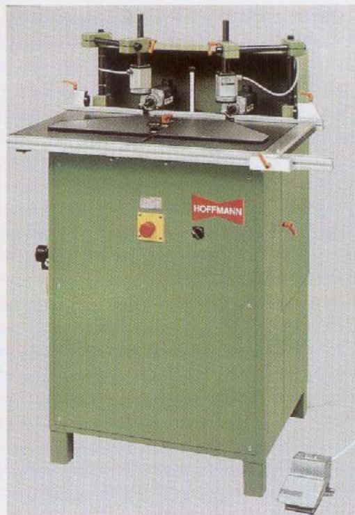
Taladro horizontal de dos ejes.
