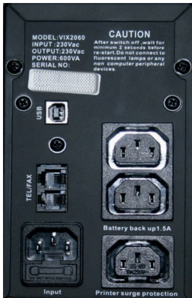
2.1. Vista trasera de un SAI que muestra los conectores IEC320 para alimentación y USB para datos.
