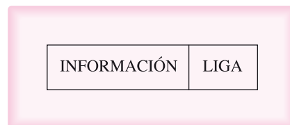
FIGURA 5.1 Estructura de un nodo.
