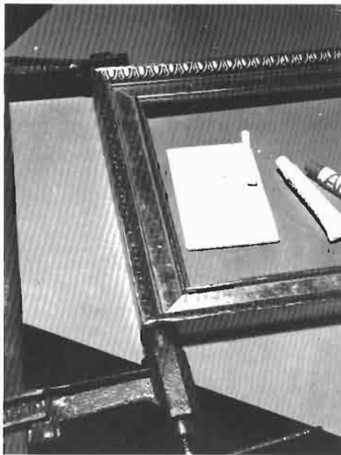
Encolado de un marco sirviéndonos de una cárcel y de una cola epoxidica de tipo rápido.
