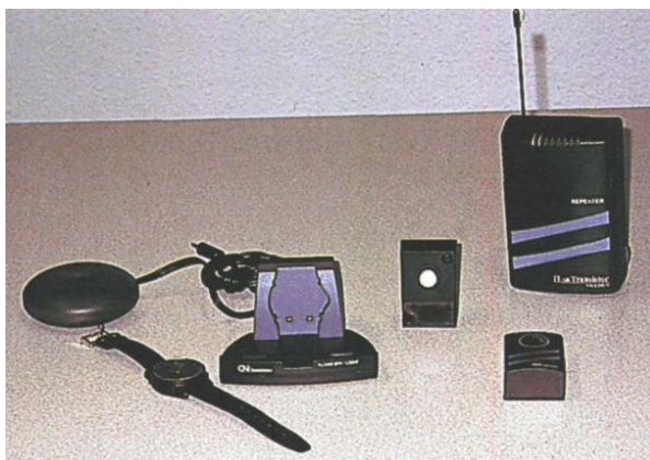
Foto 6. Sistema Tactum GNTransistor. De izquierda a derecha: receptor de muñeca, base cargador con el vibrador, timbre de la puerta y transmisores
