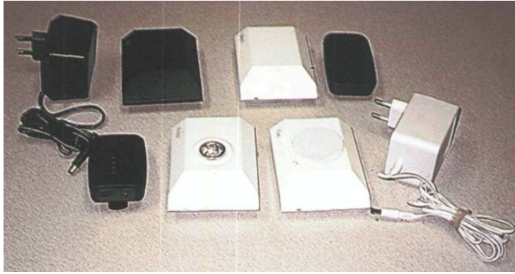
Foto 5. Sistema Puzzle. De izquierda a derecha y de abajo arriba: receptor portátil por vibración, indicadores mediante luz y mediante sonido, transmisor del sonido para TV, aparato Detec transmisor de sonidos y transmisor del sonido del llanto del bebé
