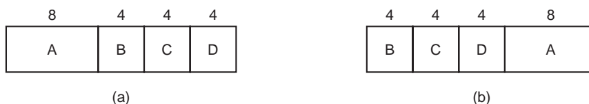
Figura 2-40. Un ejemplo de planificación tipo el trabajo más corto primero. (a) Ejecución de cuatro trabajos en el orden original. (b) Ejecución de cuatro trabajos en el orden del tipo “el trabajo más corto primero”.
