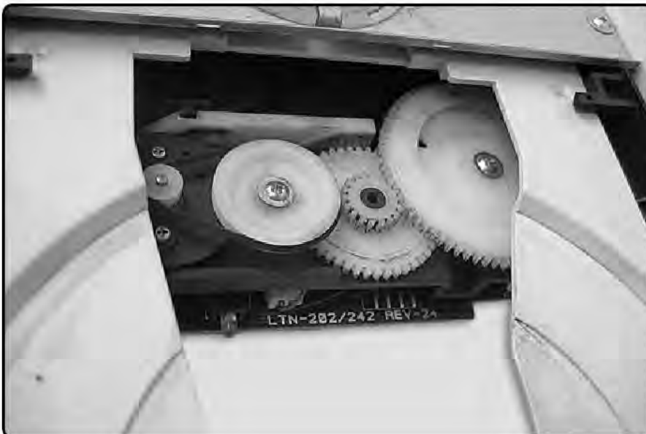
FIGURA 5. La correa, de color negro, transmite el movimiento desde el motor hacia la bandeja portadiscos.
