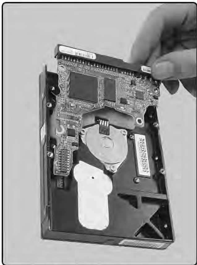
FIGURA 4. Después de quitar los tornillos, retiramos la placa lógica del resto del disco duro; ésta puede cambiarse sólo por otra de características similares.
