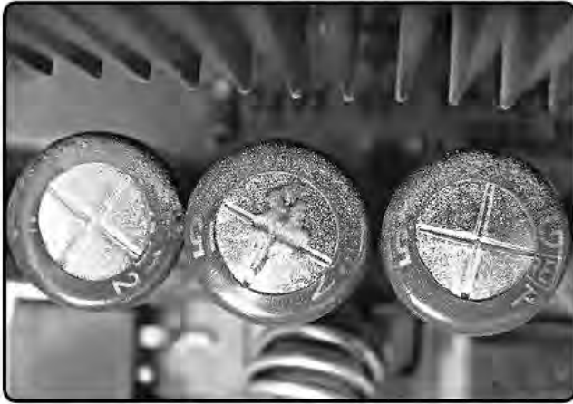
FIGURA 3. Capacitores de la placa madre cercanos al procesador; en este caso, el del centro está inflado y ha perdido líquido.
