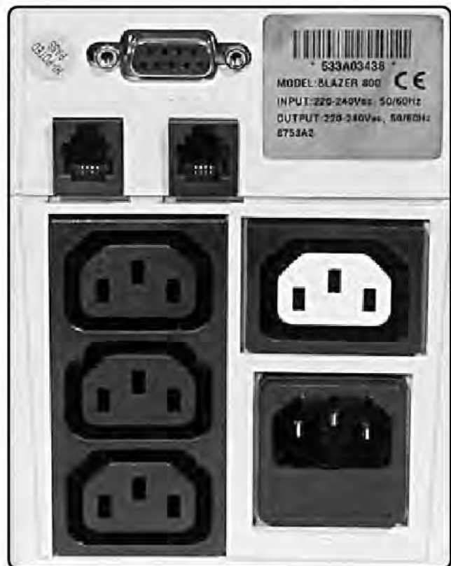
FIGURA 5. En esta imagen, observamos la parte trasera de una unidad UPS o SAI. Algunos modelos incluyen salidas de 110 y 220 voltios.
