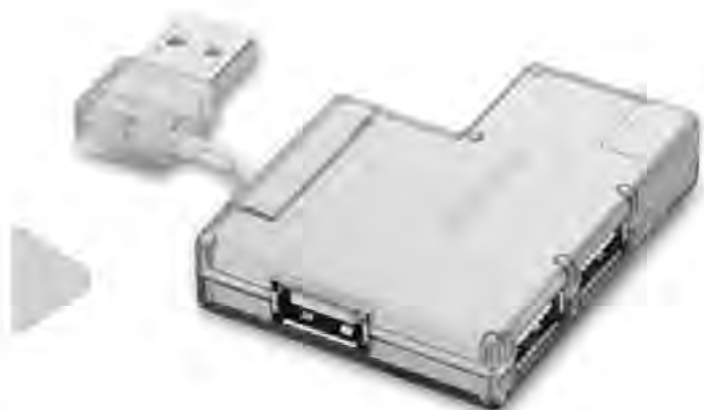
FIGURA 2. Un hub USB es un pequeño dispositivo utilizado para multiplicar los puertos USB de la PC.
