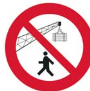
Prohibido dejar carga suspendida sin vigilancia
