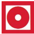
Pulsador de alarma
