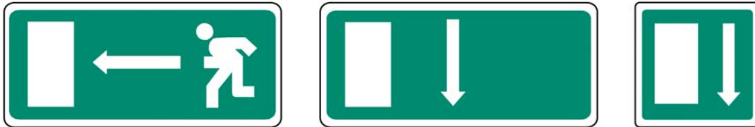
Puertas o salidas de emergencia
