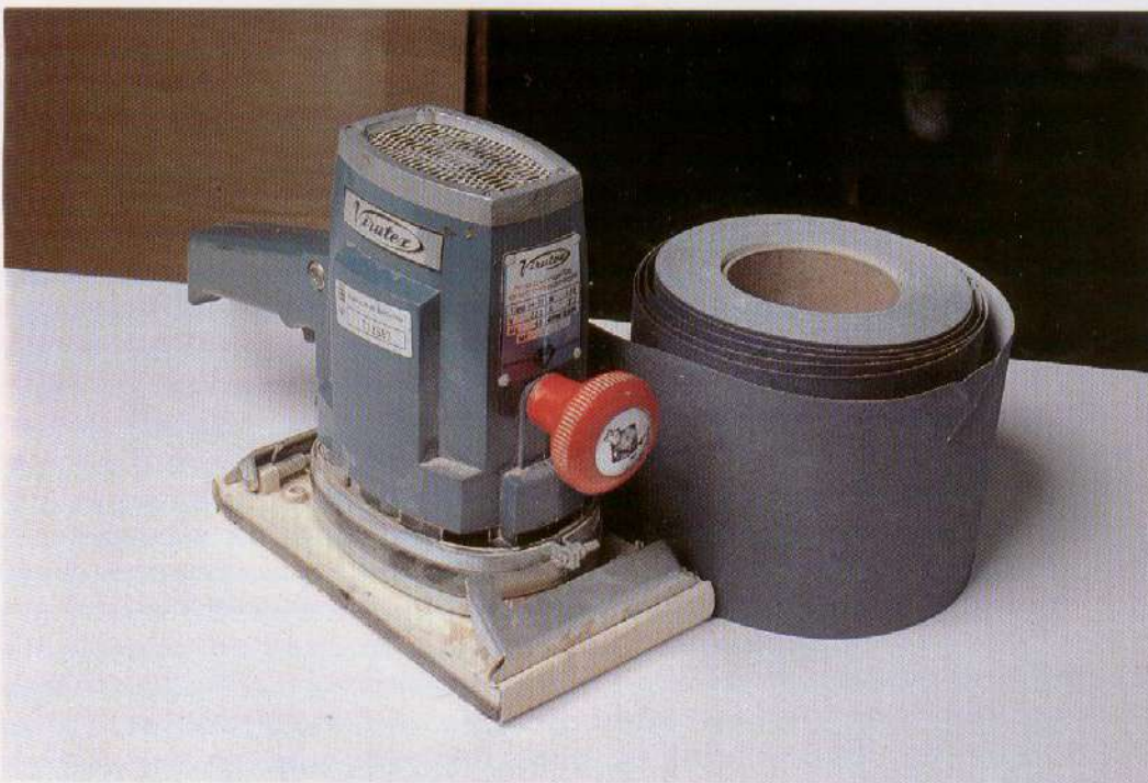
Lijadora vibratoria manual y rollo de lija. Esta máquina, junto con las de banda manual, se usa en el lijado mecánico por procedimientos manuales.
