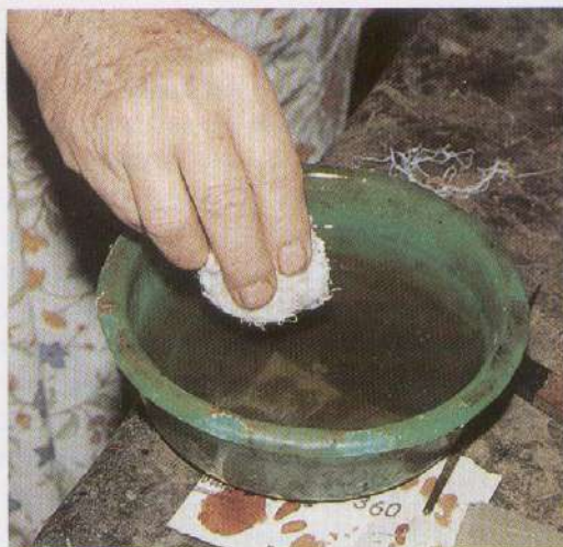
Aplicación de barniz con cabos.
