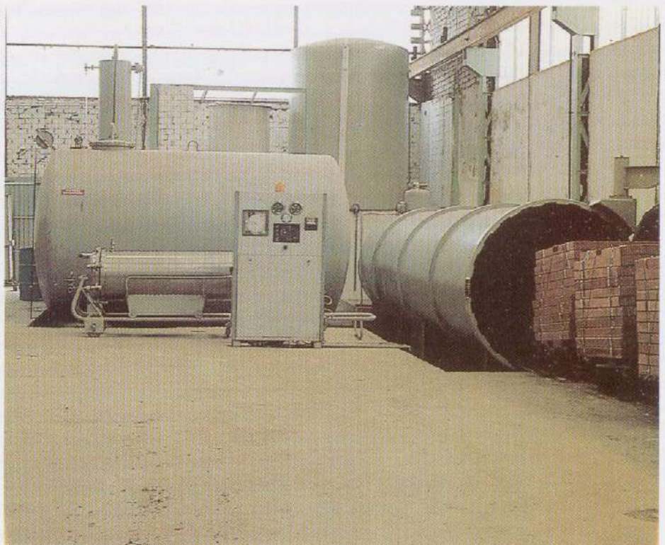
Aplicación industrial de la preservación de la madera por autoclave.
