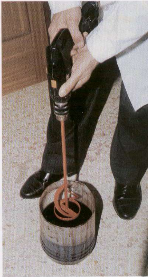
Sencillo sistema de agitación mecánica. Una simple varilla con una hélice acoplada a un taladro es muy útil para agitar y mezclar los barnices y las lacas.
