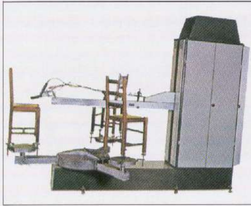
Robot automático de aplicación electrostática.
