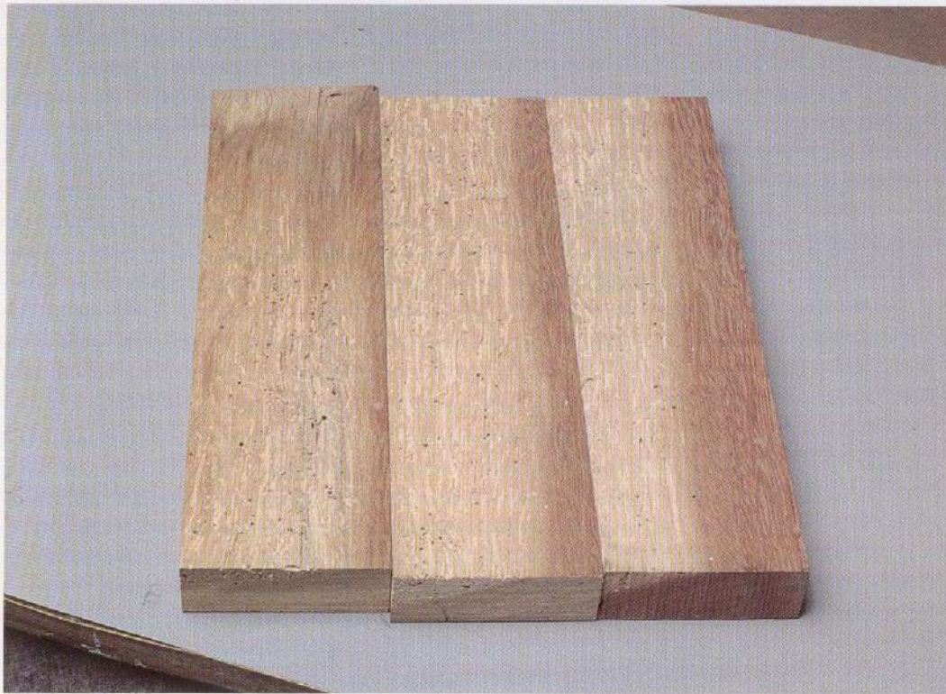
Madera carcomida por los insectos. Pueden observarse los agujeros carcomidos.
