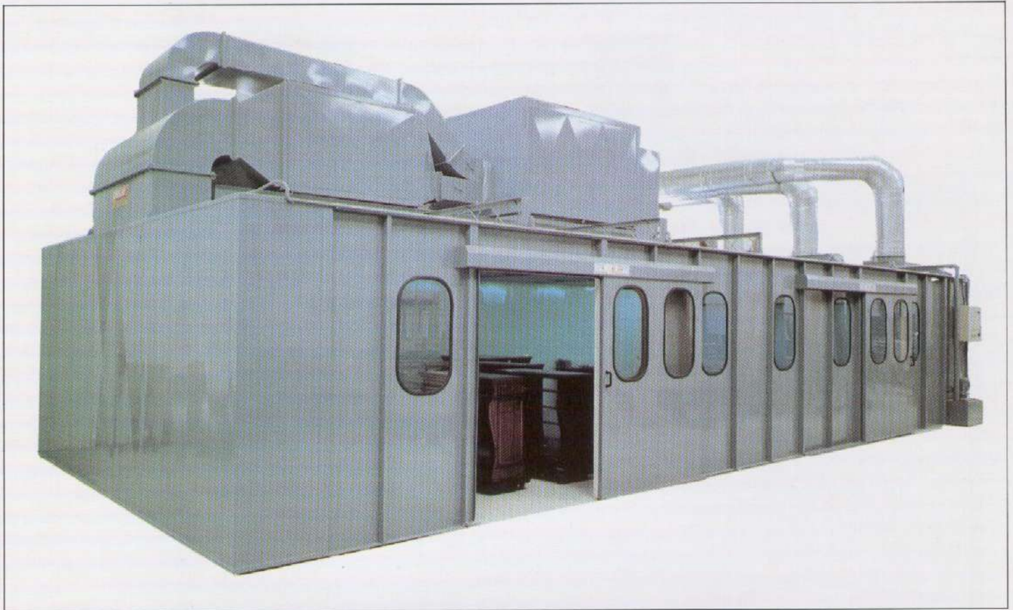
Cabina industrial de cortina de agua, presurizada y climatizada.
