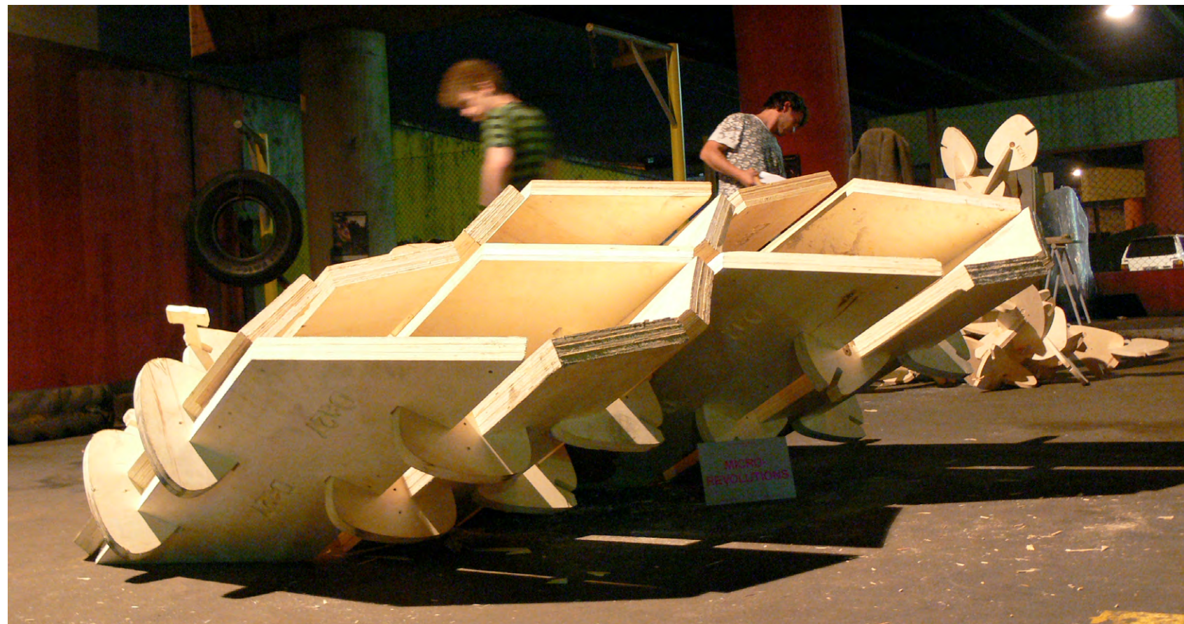
Fig. 2 - Alunos da oficina montando as peças do mobiliário urbano executadas em máquina router de fabricação digital. Foto SUBdv.
