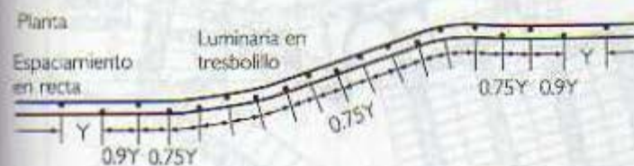
Croquis 15. Curva horizontal de 330 m de radio y sobreelevación de 0.18 cm por metro
