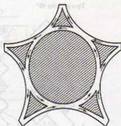
Glorieta de cinco ramas con isleta circular o alargada, dependiendo de las condiciones de flujo
