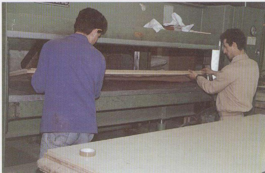
interesante que estas colas tengan un fraguado rápido (menor tiempo de uso en la prensa) y una resistencia elevada a la tracción, conseguida en poco tiempo.
