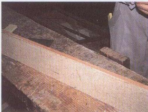
se debe a la acción de la temperatura y la humedad, que en realidad vienen a realizar un proceso de vaporizado. El problema es más acusado en las chapas más húmedas y con la temperatura de la prensa muy elevada. Las manchas pueden ser también provocadas por los productos resinosos que tienen algunas maderas; en estos casos desaparecen frotando con un disolvente.
