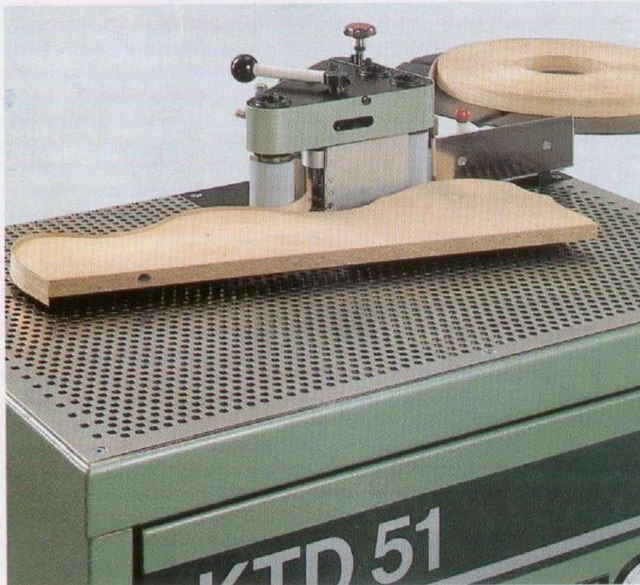
Aplacadora de cantos en rollo continuo con aplicación directa de colas termofusibles.
