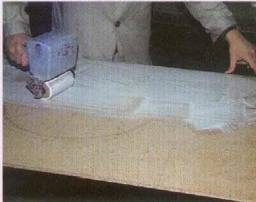
Para la aplicación de cola blanca en superficies grandes se usa un rodillo con depósito.
