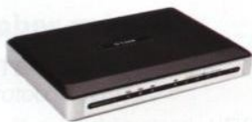
↑ Firewall mediante hardware. Router + Firewall de la compañía D-Link
