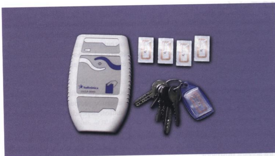
↑ Lector de tarjetas de proximidad de la empresa Softrónica (Madrid). Junto al lector hay cuatro llaves y otra más en funda de plástico colgada del llavero.
