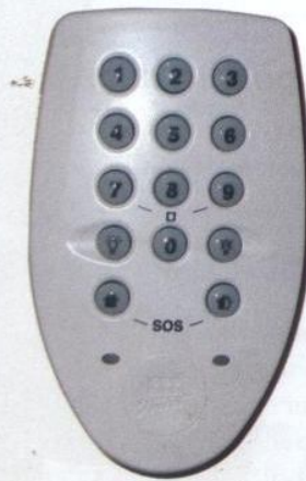
↑ Consola de activación y desactivación de dos niveles: un nivel para toda el área protegida y otro para una subárea.
