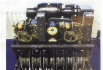
→ Máquina Lorenz , utilizada en la Segunda Guerra Mundial para cifrar comunicaciones telegáficas de alto nivel militar.
