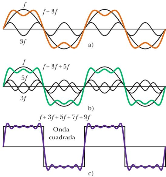
**Figura 18.20** Síntesis de Fourier de una onda cuadrada, que se representa mediante la suma de múltiplos impares del primer armónico, que tiene frecuencia  $f$ . a) Se suman ondas de frecuencia  $f$  y  $3f$ . b) Se agrega un armónico impar más de frecuencia  $5f$ . c) La curva de síntesis se aproxima más a la onda cuadrada cuando se suman las frecuencias impares hasta  $9f$ .
