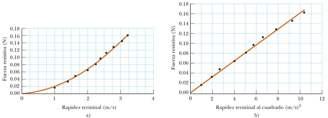
**Figura 6.16** (Ejemplo 6.10) a) Correspondencia entre la fuerza resistiva que actúa sobre filtros de café que caen y su rapidez terminal. La línea curva es un ajuste polinomial de segundo orden. b) Gráfica que relaciona la fuerza resistiva con el cuadrado de la rapidez terminal. El ajuste de la línea recta a los puntos de información indica que la fuerza resistiva es proporcional al cuadrado de la rapidez terminal. ¿Puede encontrar la constante de proporcionalidad?
