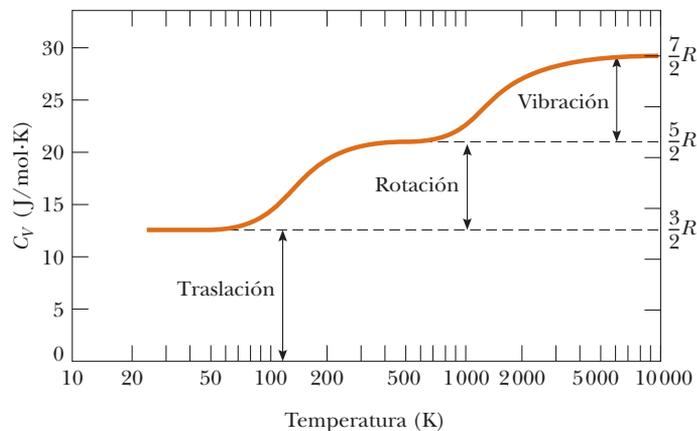
**Figura 21.7** Calor específico molar del hidrógeno como función de la temperatura. La escala horizontal es logarítmica. Note que el hidrógeno se licua a 20 K.
