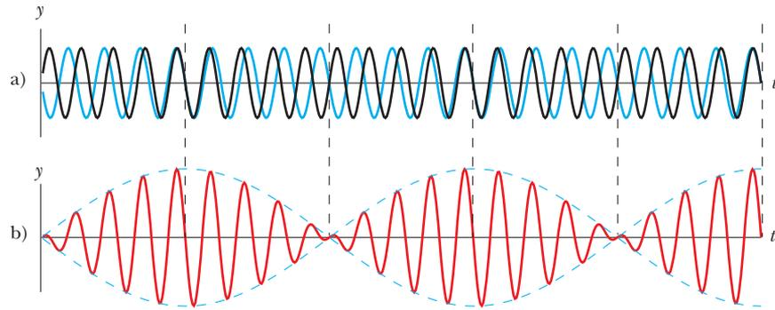
**Figura 18.17** Los batimientos se forman por la combinación de dos ondas de frecuencias ligeramente diferentes. a) Ondas individuales. b) Onda combinada. La onda envolvente (línea discontinua) representa el batimiento de los sonidos combinados.
