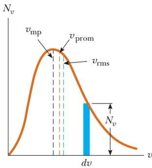
**Figura 21.10** Distribución de rapidez de moléculas de gas a cierta temperatura. El número de moléculas que tienen magnitudes de velocidad en el intervalo de  $v$  a  $v + dv$  es igual al área del rectángulo coloreado,  $N_v dv$ . La función  $N_v$  tiende a cero a medida que  $v$  tiende a infinito.
