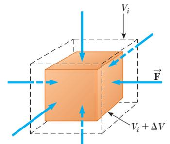
**Figura 12.15** Cuando un sólido está bajo presión uniforme, experimenta un cambio en volumen, pero no un cambio en forma. Este cubo se comprime en todos sus lados mediante fuerzas normales a sus seis caras.
