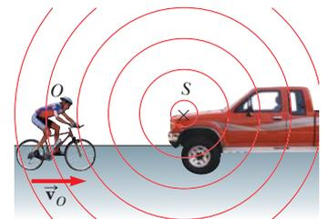
**Figura 17.8** Un observador  $O$  (el ciclista) se mueve con una rapidez  $v_o$  hacia una fuente puntual estable  $S$ , el claxon de una camioneta estacionada. El observador escucha una frecuencia  $f'$  mayor que la frecuencia de la fuente.
