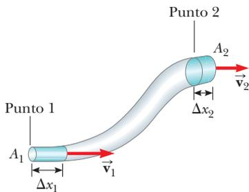
**Figura 14.16** Un fluido que se mueve con flujo estable de sección a través de una tubería de área transversal variable. El volumen de fluido que fluye a través del área  $A_1$  en un intervalo de tiempo  $\Delta t$  debe ser igual al volumen que fluye a través del área  $A_2$  en el mismo intervalo de tiempo. Por lo tanto,  $A_1 v_1 = A_2 v_2$ .
