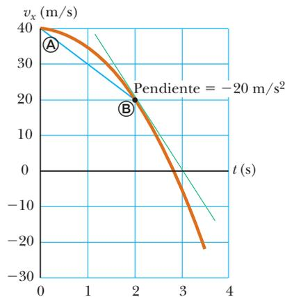
**Figura 2.9** (Ejemplo 2.6) Gráfica velocidad-tiempo para una partícula que se mueve a lo largo del eje  $x$  de acuerdo con la expresión  $v_x = (40 - 5t^2)$  m/s. La aceleración en  $t = 2$  s es igual a la pendiente de la línea tangente verde en dicho tiempo.
