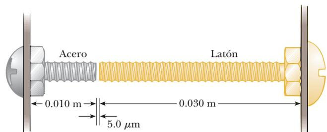
**Figura 19.10** (Ejemplo 19.3) Dos tornillos unidos a diferentes partes de un dispositivo eléctrico casi se tocan cuando la temperatura es de  $27^\circ\text{C}$ . A medida que la temperatura aumenta, los extremos de los tornillos se mueven uno hacia el otro.
