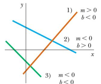
**Figura B.2** La línea café tiene una pendiente positiva y una ordenada al origen negativa. La línea azul tiene una pendiente negativa y una ordenada al origen positiva. La línea verde tiene una pendiente negativa y una ordenada al origen negativa.
