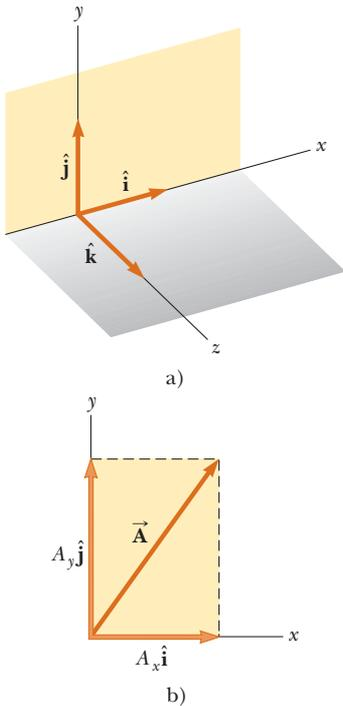
**Figura 3.14** a) Los vectores unitarios  $\hat{i}$ ,  $\hat{j}$  y  $\hat{k}$  se dirigen a lo largo de los ejes  $x$ ,  $y$  y  $z$ , respectivamente. b) El vector  $\vec{A} = A_x \hat{i} + A_y \hat{j}$  que se encuentra en el plano  $xy$  tiene componentes  $A_x$  y  $A_y$ .
