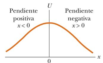
**Figura 7.21** Gráfica de  $U$  con  $x$  para una partícula que tiene una posición de equilibrio inestable ubicada en  $x = 0$ . Para cualquier desplazamiento finito de la partícula, la fuerza sobre la partícula se dirige alejándose de  $x = 0$ .
