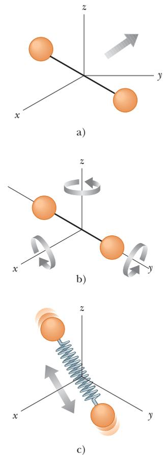
**Figura 21.6** Posibles movimientos de una molécula diatómica: a) movimiento traslacional del centro de masa, b) movimiento rotacional en torno a los diferentes ejes  $y$  y  $z$ , c) movimiento vibratorio a lo largo del eje molecular.
