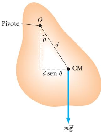
**Figura 15.17** Un péndulo físico con centro de eje en  $O$ .
