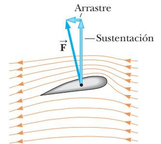
**Figura 14.21** Flujo de línea de corriente alrededor del ala de un avión en movimiento. El aire que se aproxima desde la derecha se desvía hacia abajo por el ala. Por la tercera ley de Newton, esta desviación debe coincidir con una fuerza hacia arriba sobre el ala proveniente del aire: *sustentación*. Debido a la resistencia del aire, también hay una fuerza opuesta a la velocidad del ala: *arrastre*.
