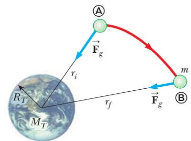
**Figura 13.10** A medida que una partícula de masa  $m$  se mueve de  $\textcircled{A}$  a  $\textcircled{B}$  sobre la superficie de la Tierra, la energía potencial gravitacional del sistema partícula–Tierra cambia de acuerdo con la ecuación 13.12.
