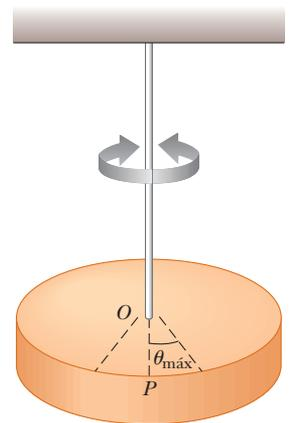
**Figura 15.19** Un péndulo de torsión consiste en un objeto rígido suspendido mediante un alambre unido a un soporte rígido. El objeto oscila en torno a la línea  $OP$  con una amplitud  $\theta_{\text{máx}}$ .
