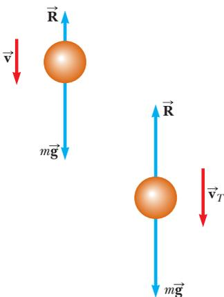
**Figura 6.14** Un objeto que cae a través del aire experimenta una fuerza resistiva  $\vec{R}$  y una fuerza gravitacional  $\vec{F}_g = m\vec{g}$ . El objeto logra la rapidez terminal (a la derecha) cuando la fuerza neta que actúa sobre él es cero; esto es: cuando  $\vec{R} = -\vec{F}_g$  o  $R = mg$ . Antes de que se presente, la aceleración varía con la rapidez de acuerdo con la ecuación 6.8.
