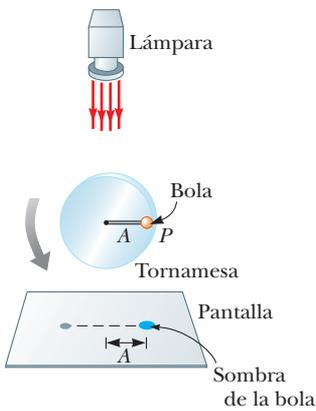
**Figura 15.13** Un arreglo experimental para demostrar la conexión entre movimiento armónico simple y movimiento circular uniforme. Conforme la bola da vueltas sobre la tornamesa con rapidez angular constante, su sombra sobre la pantalla se mueve de atrás para adelante en movimiento armónico simple.
