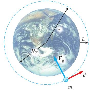
**Figura 13.8** (Ejemplo 13.5) Un satélite de masa  $m$  se mueve alrededor de la Tierra en una órbita circular de radio  $r$  con rapidez constante  $v$ . La única fuerza que actúa sobre el satélite es la fuerza gravitacional  $\vec{F}_g$ . (Dibujo hecho sin escala.)
