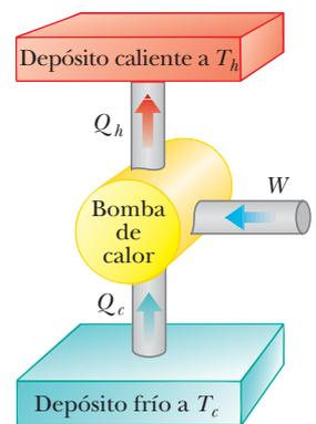
**Figura 22.4** Diagrama esquemático de una bomba de calor, que toma energía  $Q_c > 0$  de un depósito frío y expulsa energía  $Q_h < 0$  a un depósito caliente. El trabajo  $W$  se invierte en la bomba de calor. Un refrigerador funciona de la misma forma.
