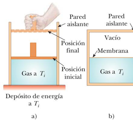
**Figura 20.6** a) Un gas a temperatura  $T_i$  se expande lentamente mientras absorbe energía de un depósito para mantener una temperatura constante. b) Un gas se expande rápidamente en una región evacuada después de que se rompe una membrana.
