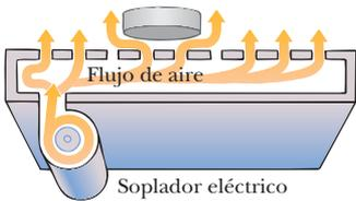
**Figura 5.3** En una mesa de hockey de aire, el aire que sopla a través de los hoyos en la superficie permite que el disco se mueva casi sin fricción. Si la mesa no acelera, un disco colocado sobre la mesa permanecerá en reposo.
