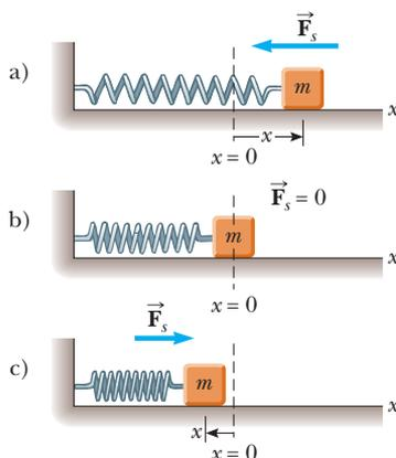
**Figura 15.1** Un bloque unido a un resorte móvil sobre una superficie sin fricción. a) Cuando el bloque se desplaza hacia la derecha del equilibrio ( $x > 0$ ), la fuerza que ejerce el resorte actúa hacia la izquierda. b) Cuando el bloque está en su posición de equilibrio ( $x = 0$ ), la fuerza que ejerce el resorte es cero. c) Cuando el bloque se desplaza hacia la izquierda del equilibrio ( $x < 0$ ), la fuerza que ejerce el resorte actúa hacia la derecha.
