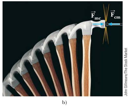
**Figura 5.5** Tercera ley de Newton. a) La fuerza  $\vec{F}_{12}$  que ejerce el objeto 1 sobre el objeto 2 es igual en magnitud y opuesta en dirección a la fuerza  $\vec{F}_{21}$  que ejerce el objeto 2 sobre el objeto 1. b) La fuerza  $\vec{F}_{mc}$  que ejerce el martillo sobre el clavo es igual en magnitud y opuesta a la fuerza  $\vec{F}_{cm}$  que ejerce el clavo sobre el martillo.
