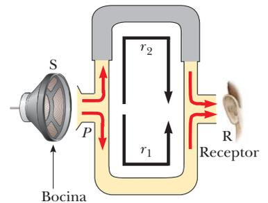
**Figura 18.4** Un sistema acústico para demostrar la interferencia de las ondas de sonido. Una onda de sonido de la bocina (S) se propaga en un tubo y se divide en dos partes en el punto P. Las dos ondas, que se combinan en el lado opuesto, son detectadas por el receptor (R). La longitud de trayectoria superior  $r_2$  puede variar al deslizar la sección superior.
