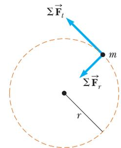
**Figura 10.15** Una partícula que da vueltas en un círculo bajo la influencia de una fuerza tangencial neta  $\Sigma \vec{F}_t$ . También debe estar presente una fuerza neta  $\Sigma \vec{F}_r$  en la dirección radial para mantener el movimiento circular.
