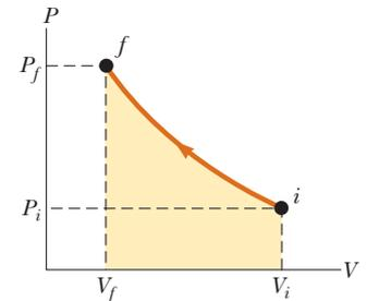
**Figura 20.4** Se comprime un gas cuasi estáticamente (con lentitud) desde el estado  $i$  hasta el estado  $f$ . El trabajo invertido sobre el gas es igual al negativo del área bajo la curva  $PV$ . El volumen disminuye, así que esta área es negativa. Por lo tanto el trabajo invertido sobre el gas es positivo. Un agente externo debe hacer trabajo positivo sobre el gas para comprimirlo.
