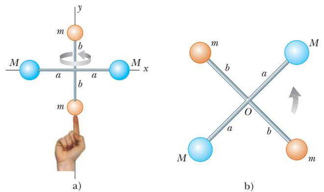
**Figura 10.8** (Ejemplo 10.3) Cuatro esferas forman un bastón inusual. a) El bastón rota en torno al eje  $y$ . b) El bastón rota en torno al eje  $z$ .
