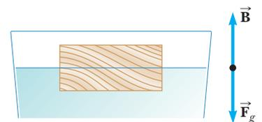
**Figura 14.10** Un objeto que flota sobre la superficie de un fluido experimenta dos fuerzas, la fuerza gravitacional  $\vec{F}_g$  y la fuerza de flotación  $\vec{B}$ . Puesto que el objeto flota en equilibrio,  $B = F_g$ .
