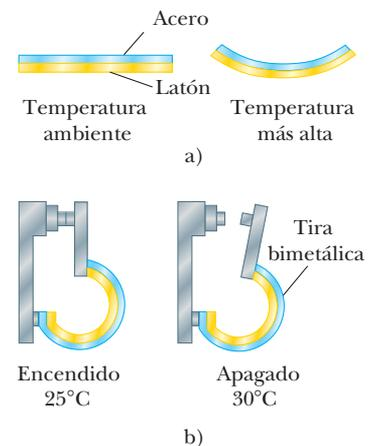
**Figura 19.9** a) Una tira bimetalica se dobla a medida que la temperatura cambia, porque los dos metales tienen diferentes coeficientes de expansión. b) Una tira bimetalica usada en un termostato para interrumpir o hacer contacto eléctrico.
