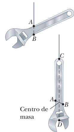
**Figura 9.16** Una técnica experimental para determinar el centro de masa de una llave de tuerca. La llave de tuerca cuelga libremente, primero del punto  $A$  y luego del punto  $C$ . La intersección de las dos líneas  $AB$  y  $CD$  ubica el centro de masa.
