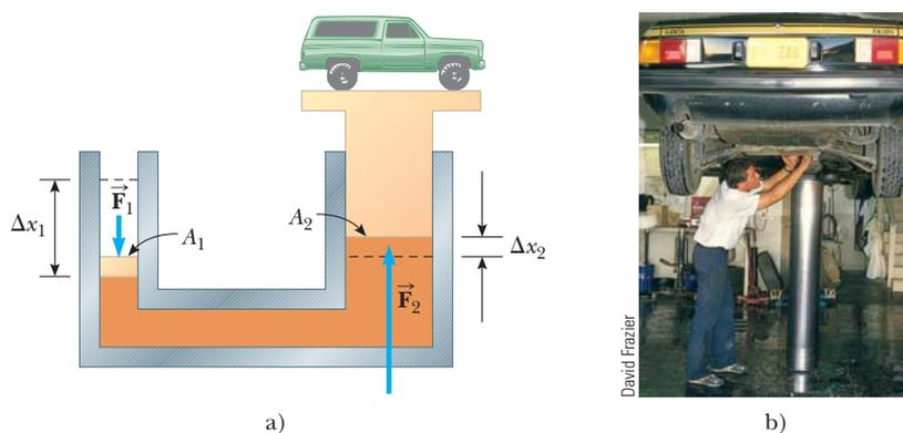
**Figura 14.4** a) Diagrama de una prensa hidráulica. Ya que el aumento en presión es el mismo en los dos lados, una pequeña fuerza  $\vec{F}_1$  a la izquierda produce una fuerza mucho mayor  $\vec{F}_2$  a la derecha. b) Un vehículo en reparación levantado mediante un elevador hidráulico en un taller.
