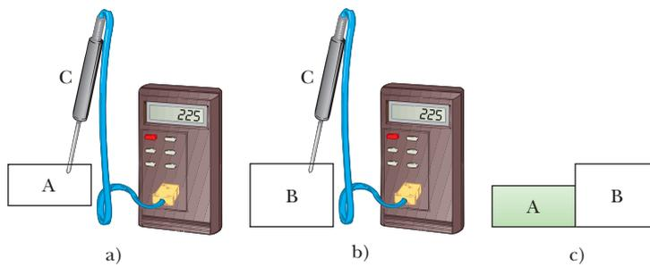
**Figura 19.1** Ley cero de la termodinámica (a, b). Si las temperaturas de A y B se miden como iguales al colocarlas en contacto térmico con un termómetro (objeto c), no se intercambiará energía entre ellos cuando se coloquen en contacto térmico mutuo c).
