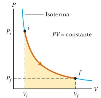
**Figura 20.8** Diagrama  $PV$  para una expansión isotérmica de un gas ideal desde un estado inicial hasta un estado final. La curva es una hipérbola.
