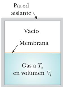
**Figura 22.14** Expansión libre adiabática de un gas. Cuando se rompe la membrana que separa al gas de la región evacuada, el gas se expande libre e irreversiblemente. Como resultado, ocupa un mayor volumen final. El contenedor está térmicamente aislado de sus alrededores; por lo tanto,  $Q = 0$ .
