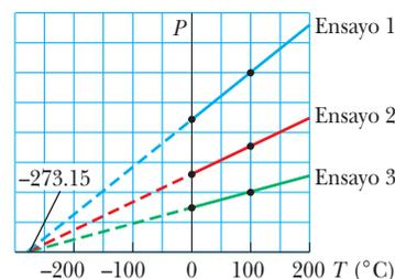
**Figura 19.5** Presión con temperatura para ensayos experimentales en gases que tienen diferentes presiones en un termómetro de gas a volumen constante. Note que, para los tres ensayos, la presión se extrapola a cero en la temperatura  $-273.15^{\circ}\text{C}$ .
