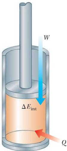
**Figura 20.7** La primera ley de la termodinámica iguala el cambio en energía interna  $E_{\text{int}}$  en un sistema con la transferencia de energía neta al sistema mediante calor  $Q$  y trabajo  $W$ . En la situación que se muestra aquí, la energía interna del gas aumenta.
