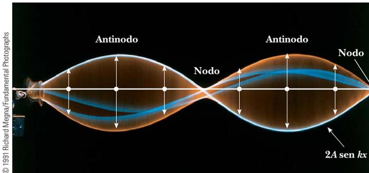
**Figura 18.7** Fotografía múltiple de una onda estacionaria en una cuerda. El comportamiento temporal del desplazamiento vertical desde el equilibrio de un elemento individual de la cuerda se conoce por  $\cos \omega t$ . Es decir, cada elemento vibra con una frecuencia angular  $\omega$ . La amplitud de la oscilación vertical de cualquier elemento de la cuerda depende de la posición horizontal del elemento. Cada elemento vibra dentro de los confines de la función envolvente  $2A \sin kx$ .
