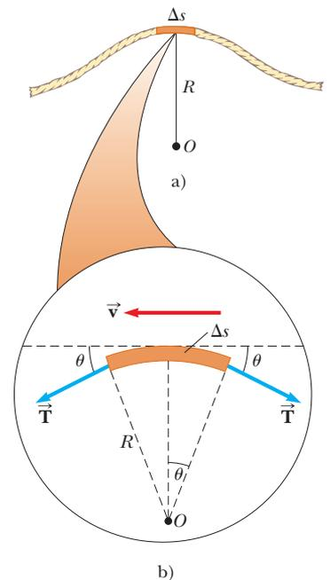
**Figura 16.11** a) Para obtener la rapidez  $v$  de una onda en una cuerda estirada, es conveniente describir el movimiento de un pequeño elemento de la cuerda en un marco de referencia en movimiento. b) En el marco de referencia en movimiento, el pequeño elemento de longitud  $\Delta s$  se mueve hacia la izquierda con rapidez  $v$ . La fuerza neta en el elemento está en la dirección radial porque se cancelan las componentes horizontales de la fuerza de tensión.
