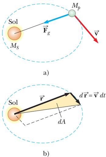
**Figura 13.6** a) La fuerza gravitacional que actúa sobre un planeta se dirige hacia el Sol. b) Conforme un planeta orbita el Sol, el área que barre el radio vector en un intervalo de tiempo  $dt$  es igual a la mitad del área del paralelogramo formado por los vectores  $\vec{r}$  y  $d\vec{r} = \vec{v} dt$ .
