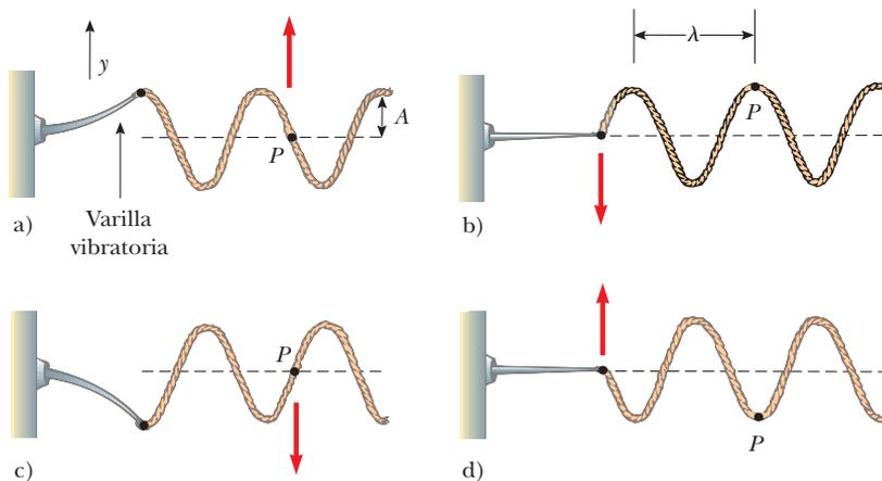
**Figura 16.10** Un método para producir una onda sinusoidal sobre una cuerda. El extremo izquierdo de la cuerda se conecta a una varilla que se pone a oscilar. Cualquier elemento de la cuerda, como el que se encuentra en el punto  $P$ , oscila con movimiento armónico simple en la dirección vertical.
