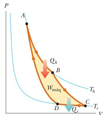
**Figura 22.10** Diagrama  $PV$  para el ciclo de Carnot. El trabajo neto realizado  $W_{\text{máq}}$  es igual a la energía neta transferida en la máquina de Carnot en un ciclo,  $|Q_h| - |Q_c|$ . Como con cualquier ciclo, el trabajo consumido durante el ciclo es el área encerrada por la trayectoria en el diagrama  $PV$ . Note que  $\Delta E_{\text{int}} = 0$  para el ciclo.
