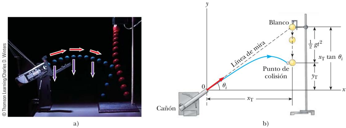
**Figura 4.12** (Ejemplo 4.3) a) Fotografía estroboscópica de la demostración proyectil–objetivo. Si el cañón se apunta directamente al objetivo y se dispara en el mismo instante cuando el objetivo comienza a caer, el proyectil golpeará el objetivo. Advierta que la velocidad del proyectil (flechas rojas) cambia en dirección y magnitud, mientras su aceleración descendente (flechas violetas) permanece constante. b) Diagrama esquemático de la demostración proyectil–objetivo.
