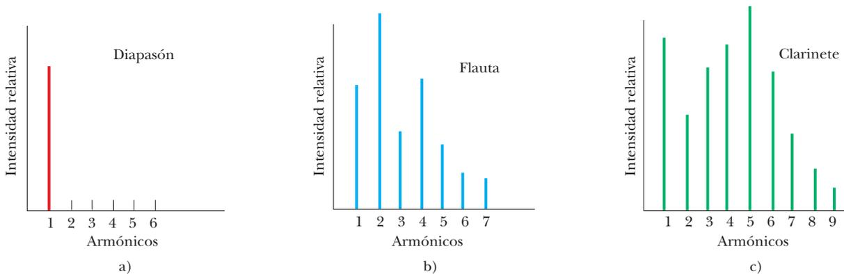
**Figura 18.19** Armónicos de los patrones de onda que se muestran en la figura 18.18. Note las variaciones en intensidad de los diferentes armónicos. Los incisos a), b) y c) corresponden a los de la figura 18.18.
