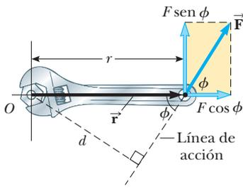
**Figura 10.12** La fuerza  $\vec{F}$  tiene una mayor tendencia de rotación en torno a un eje a través de  $O$  a medida que  $F$  aumenta y a medida que el brazo de momento  $d$  aumenta. La componente  $F \text{ sen } \phi$  tiende a dar vueltas a la llave en torno a  $O$ .
