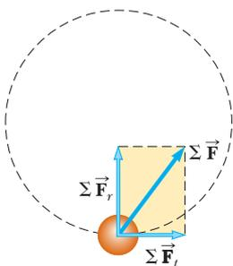
**Figura 6.7** Cuando la fuerza neta que actúa sobre una partícula móvil en una trayectoria circular tiene una componente tangencial  $\Sigma F_t$ , la rapidez de la partícula cambia. La fuerza neta que se ejerce sobre la partícula en este caso es la suma vectorial de la fuerza radial y la fuerza tangencial. Esto es,  $\Sigma \vec{F} = \Sigma \vec{F}_r + \Sigma \vec{F}_t$ .
