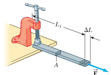
**Figura 12.12** Una barra larga, sujeta en un extremo, se estira una cantidad  $\Delta L$  bajo la acción de una fuerza  $\vec{F}$ .
