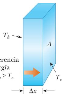
**Figura 20.10** Transferencia de energía a través de una placa conductora con un área de sección transversal  $A$  y un grosor  $\Delta x$ . Las caras opuestas están a diferentes temperaturas  $T_c$  y  $T_h$ .
