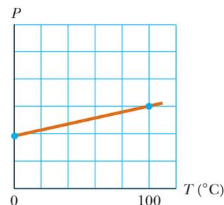
**Figura 19.4** Una gráfica representativa de presión con temperatura tomada con un termómetro de gas a volumen constante. Los dos puntos representan temperaturas de referencia conocidas (los puntos de hielo y vapor del agua).
