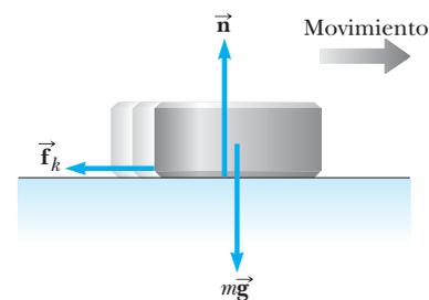
**Figura 5.19** (Ejemplo 5.12) Después de que al disco se le da una velocidad inicial hacia la derecha, las únicas fuerzas externas que actúan sobre él son la fuerza gravitacional  $m\vec{g}$ , la fuerza normal  $\vec{n}$  y la fuerza de fricción cinética  $\vec{f}_k$ .
