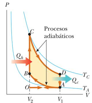
**Figura 22.12** Diagrama  $PV$  para el ciclo de Otto, que representa aproximadamente los procesos que ocurren en un motor de combustión interna.
