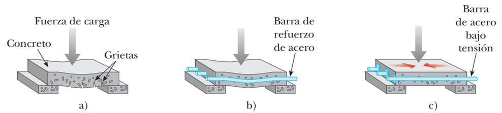
**Figura 12.16** a) Una losa de concreto sin refuerzo tiende a romperse bajo una carga pesada. b) La resistencia del concreto aumenta con el uso de barras de refuerzo de acero. c) El concreto se fortalece aún más al pretensado con barras de acero bajo tensión.
