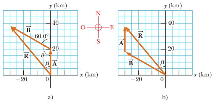
**Figura 3.11** (Ejemplo 3.2) a) Método gráfico para encontrar el vector de desplazamiento resultante  $\vec{R} = \vec{A} + \vec{B}$ . b) Sumar los vectores en orden inverso ( $\vec{B} + \vec{A}$ ) da el mismo resultado para  $\vec{R}$ .
