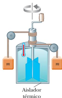
**Figura 20.1** Experimento de Joule para determinar el equivalente mecánico del calor. Los bloques que caen hacen girar la rueda de paletas, lo que a su vez causa el aumento de temperatura del agua.
