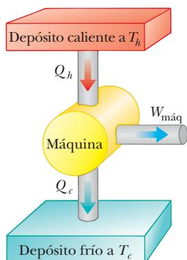
**Figura 22.2** Representación esquemática de una máquina térmica. La máquina realiza trabajo  $W_{\text{máq}}$ . La flecha en la parte superior representa energía  $Q_h > 0$  que entra a la máquina. En el fondo,  $Q_c < 0$  representa la energía que sale de la máquina.
