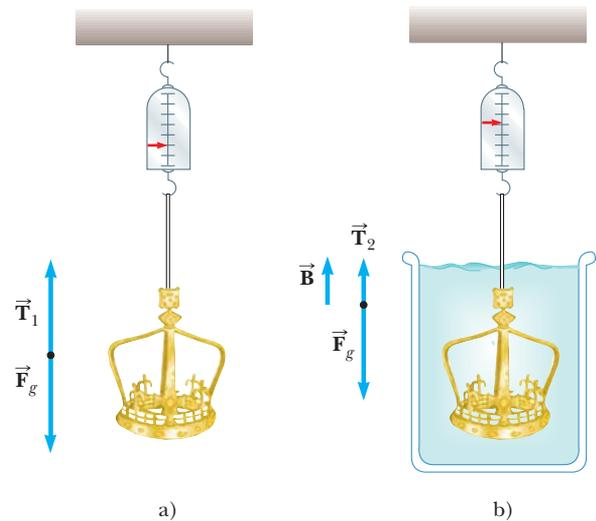
**Figura 14.11** (Ejemplo 14.5) a) Cuando la corona está suspendida en aire, la lectura en la balanza es su peso real porque  $T_1 = F_g$  (la flotabilidad del aire es despreciable). b) Cuando la corona se sumerge en agua, la fuerza de flotación  $\vec{B}$  cambia la lectura de la balanza a un valor menor  $T_2 = F_g - B$ .
