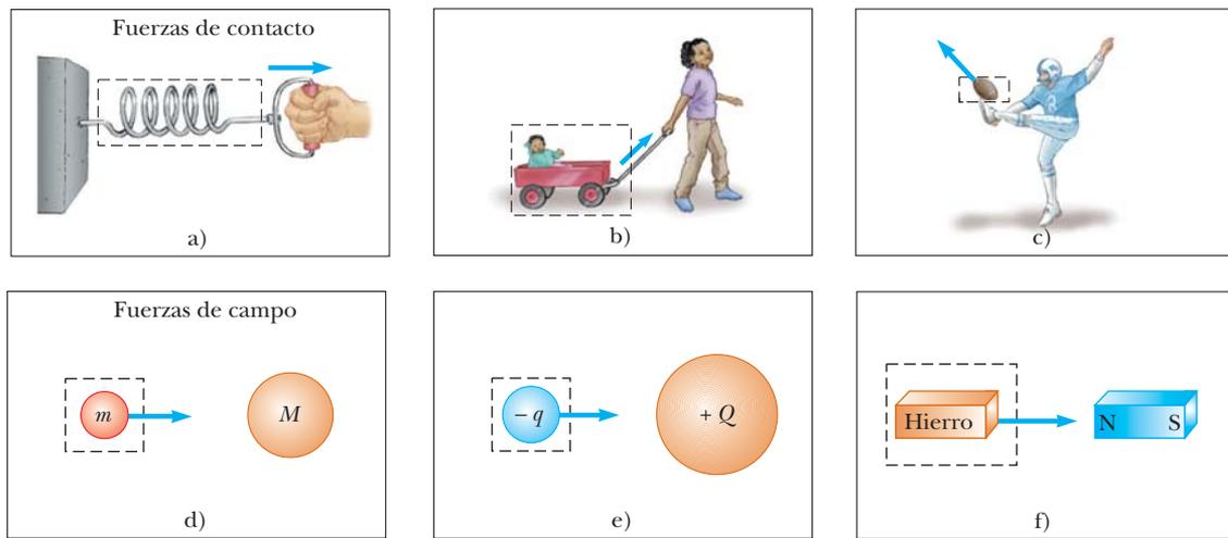
**Figura 5.1** Algunos ejemplos de fuerzas aplicadas. En cada caso, sobre el objeto dentro del área limitada por líneas discontinuas se ejerce una fuerza. Algún agente en el ambiente exterior al área del recuadro ejerce una fuerza sobre el objeto.
