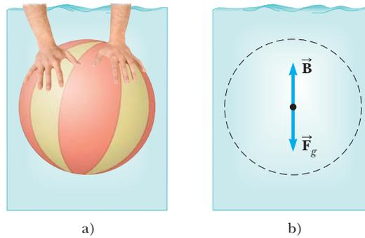
**Figura 14.7** a) Un nadador empuja una pelota de playa bajo el agua. b) Las fuerzas sobre una porción de agua del tamaño de una pelota de playa. La fuerza de flotación  $\vec{B}$  sobre una pelota de playa que sustituye esta porción es exactamente la misma que la fuerza de flotación sobre la porción.
