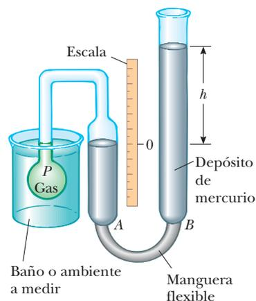
**Figura 19.3** Un termómetro de gas a volumen constante mide la presión del gas contenido en la ampollita sumergida en un baño. El volumen del gas en la celda se mantiene constante al elevar o bajar el depósito  $B$  para mantener constante el nivel de mercurio en la columna  $A$ .
