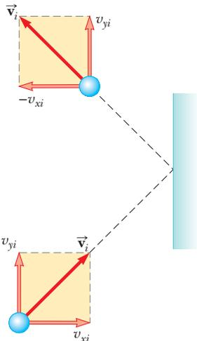
**Figura 21.2** Una molécula tiene una colisión elástica contra la pared del contenedor. Su componente  $x$  de cantidad de movimiento se invierte, mientras que su componente  $y$  permanece inalterada. En esta construcción se supone que la molécula se mueve en el plano  $xy$ .
