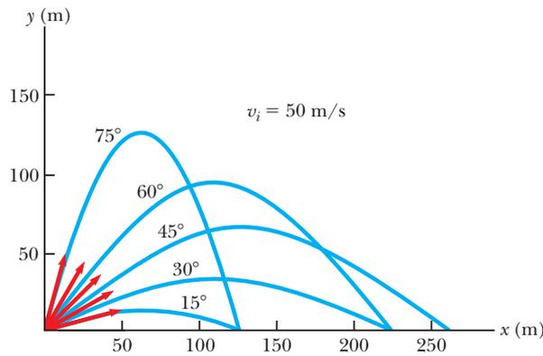
**Figura 4.10** Un proyectil lanzado sobre una superficie plana desde el origen con una rapidez inicial de 50 m/s en varios ángulos de proyección. Note que valores complementarios de  $\theta_i$  resultan en el mismo valor de  $R$  (alcance del proyectil).
