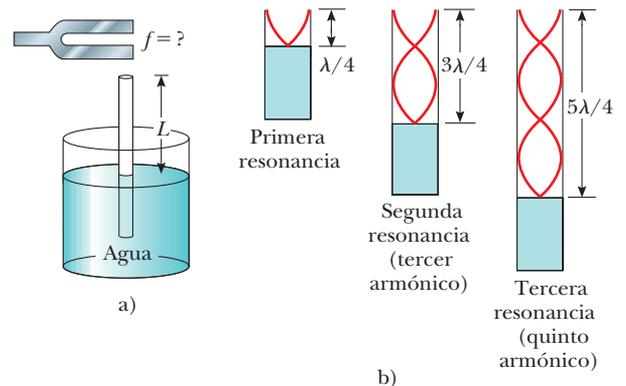
**Figura 18.14** (Ejemplo 18.6) a) Aparato para demostrar la resonancia de ondas sonoras en un tubo cerrado en un extremo. La longitud  $L$  de la columna de aire varía al mover el tubo verticalmente mientras se sumerge parcialmente en agua. b) Primeros tres modos normales del sistema que se muestra en a).
