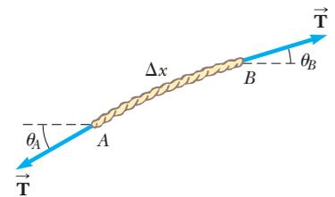
**Figura 16.19** Un elemento de cuerda bajo tensión  $T$ .
