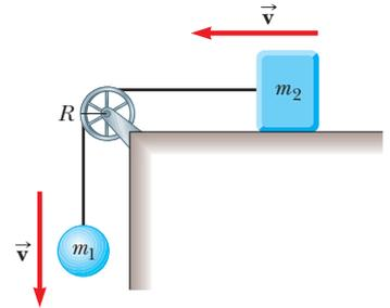
**Figura 11.6** (Ejemplo 11.4) Cuando el sistema se libera, la esfera se mueve hacia abajo y el bloque se mueve hacia la izquierda.
