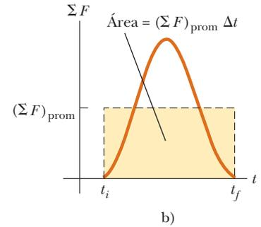
**Figura 9.3** a) Una fuerza neta que actúa sobre una partícula puede variar en el tiempo. El impulso impartido a la partícula por la fuerza es el área bajo la curva fuerza con tiempo. b) En el intervalo de tiempo  $\Delta t$ , la fuerza neta promediada en el tiempo (línea discontinua horizontal) da el mismo impulso a una partícula como lo hace la fuerza variable en el tiempo descrita en a).
