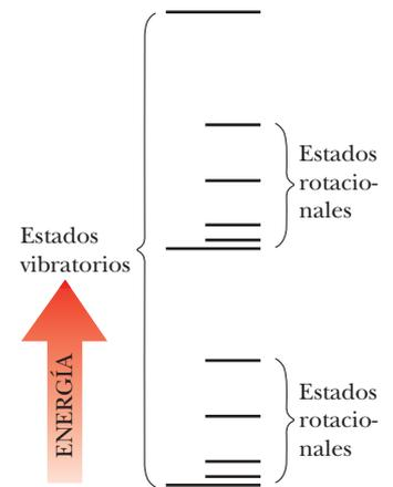
**Figura 21.8** Diagrama de niveles de energía para estados vibratorio y rotacional de una molécula diatómica. Note que los estados rotacionales se encuentran más juntos en energía que los estados vibratorios.
