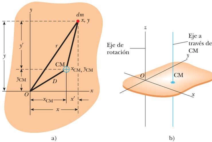
**Figura 10.11** a) Teorema de ejes paralelos. Si el momento de inercia en torno a un eje perpendicular a la figura a través del centro de masa es  $I_{CM}$ , el momento de inercia en torno al eje  $z$  es  $I_z = I_{CM} + MD^2$ . b) Dibujo en perspectiva que muestra el eje  $z$  (el eje de rotación) y el eje paralelo a través del centro de masa.
