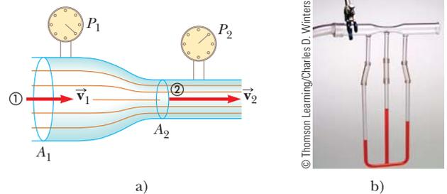
**Figura 14.19** (Ejemplo 14.8) a) La presión  $P_1$  es mayor que la presión  $P_2$  porque  $v_1 < v_2$ . Este dispositivo se usa para medir la rapidez del flujo de fluido. b) Un tubo Venturi, ubicado en la parte superior de la fotografía. El mayor nivel de fluido en la columna de en medio demuestra que la presión en lo alto de la columna, que está en la región estrecha del tubo Venturi, es menor.
