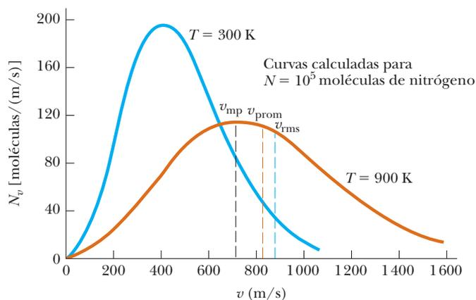
**Figura 21.11** Función de distribución de rapidez para  $10^5$  moléculas de nitrógeno a 300 K y 900 K. El área total bajo cualquier curva es igual al número total de moléculas, que en este caso es igual a  $10^5$ . Note que  $v_{rms} > v_{prom} > v_{mp}$ .
