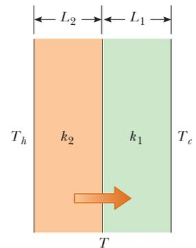
**Figura 20.13** (Ejemplo 20.8) Transferencia de energía por conducción a través de dos placas en contacto térmico mutuo. En estado estable, la rapidez de transferencia de energía a través de la placa 1 es igual a la rapidez de transferencia de energía a través de la placa 2.
