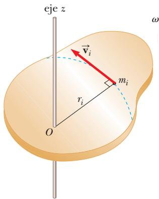
**Figura 10.7** Un objeto rígido en rotación en torno al eje z con rapidez angular  $\omega$ . La energía cinética de la partícula de masa  $m_i$  es  $\frac{1}{2}m_i v_i^2$ . La energía cinética total del objeto se llama energía cinética rotacional.
