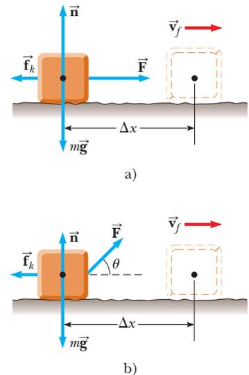
**Figura 8.8** (Ejemplo 8.4) a) Se jala un bloque hacia la derecha sobre una superficie rugosa mediante una fuerza horizontal constante. b) La fuerza aplicada está en un ángulo  $\theta$  con la horizontal.
