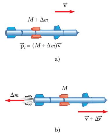
**Figura 9.23** Propulsión de cohete. a) La masa inicial del cohete más todo su combustible es  $M + \Delta m$  en un tiempo  $t$ , y su rapidez es  $v$ . b) En un tiempo  $t + \Delta t$ , la masa del cohete se redujo a  $M$  y se expulsó una cantidad de combustible  $\Delta m$ . La rapidez del cohete aumenta por una cantidad  $\Delta v$ .
