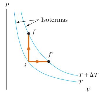
**Figura 21.4** La energía se transfiere por calor a un gas ideal en dos formas. Para la trayectoria  $i \rightarrow f$  a volumen constante, toda la energía participa en el aumento de energía interna del gas, porque no se realiza trabajo. A lo largo de la trayectoria  $i \rightarrow f'$  a presión constante, parte de la energía transferida adentro por calor se transfiere afuera por trabajo.
